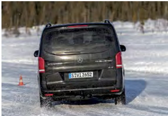
Allrad und ESP sorgen für einen erstaunlich sicheren Eichtest mitten auf einem zugefrorenen See in Schweden.
