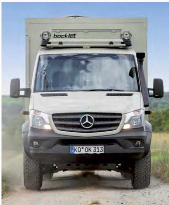
Die Frontpartie des 3,2 Meter hohen Dakar 750 mit Zusatzscheinwerfern am Dachträger und hochgelegtem Luftfilter an der A-Säule ist beeindruckend.
