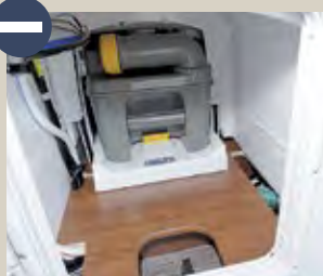
Der Schacht der Kassettentoilette wird von Hobby nicht abgedichtet.
