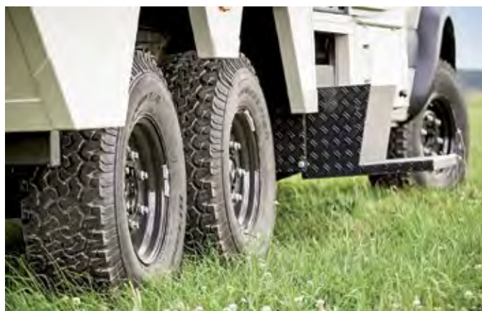
Die Wohnkabine ist im Heckbereich angeschragt, um die Geländetauglichkeit nicht einzuschränken (Bild oben). Der Oberaigner-Umbau des Sprinter auf 6x6-Antrieb und Doppel-Hinterachse dürfte ein seltener Anblick im Reisemobil-Bau bleiben.
