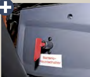
Ein Hauptschalter für die Elektronik verhindert das Entladen der Batterie.
