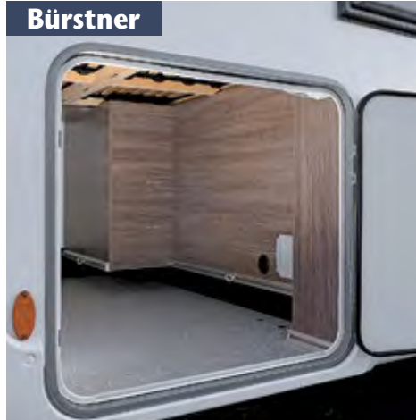
Die eintürige Heckgarage (218 x 113 x 93 cm) im Bürstner ist niedriger als die im Adria. Zudem beansprucht der Gaskasten einen Teil des Volumens.
