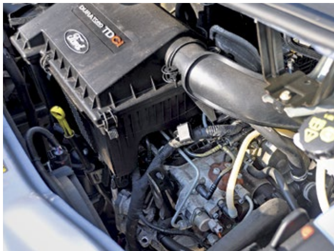
Motor und Getriebe sind trocken, Kabel und Schläuche in Ordnung.
