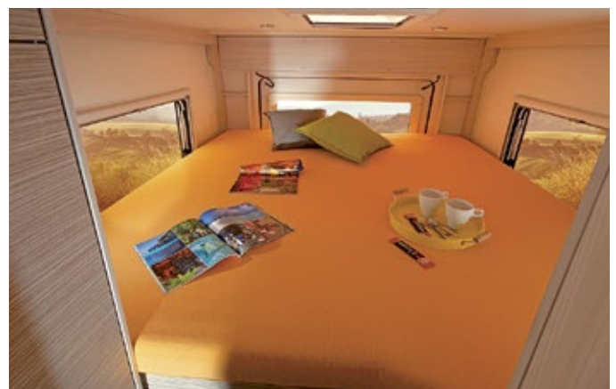
Mit 191 mal 187/183 Zentimetern ist das stabile Hubbett ungewöhnlich groß. Camper erreichen es über eine solide, herausziehbare, zweistufige Treppe.
