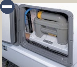
Toilettenschacht ungeschützt und mit teils lieblos verlegten Kabeln.
