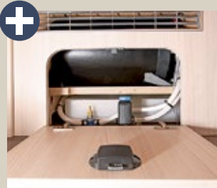
Gut erreichbares Frostschutz-Ventil über seitlicher Klappe in Sitzruhe.
