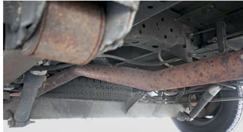
Außer am Auspuff lässt sich nur wenig Korrosion am Unterboden entdecken.
