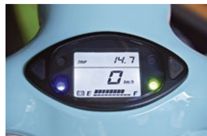
Elektrik-Trick: Unter der Sitzbank schlummern zwei Akkus. Per Stecker werden sie einzeln an den Roller angeschlossen. Der Tacho signalisiert die gefahrenen Kilometer und den Ladezustand.
