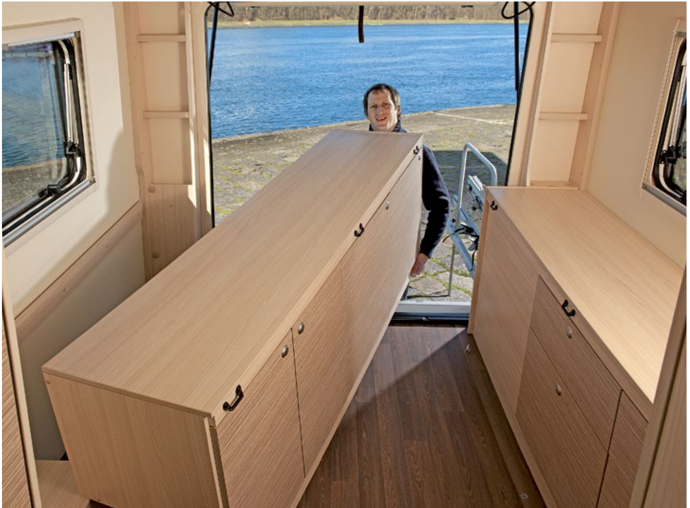
Die optionale zweite Schrankzeile lässt sich leicht entfernen, dann steht noch mehr Laderaum bereit. Zum Herausheben ist eine zweite Person erforderlich.
