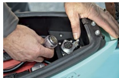
Elektrik-Trick: Unter der Sitzbank schlummern zwei Akkus. Per Stecker werden sie einzeln an den Roller angeschlossen. Der Tacho signalisiert die gefahrenen Kilometer und den Ladezustand.
