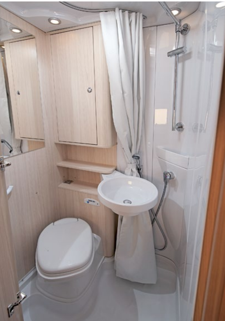
Bürstner nutzt den Raum für das Bad sehr gut aus. Den Trick, beim schwenkbaren Waschbecken die Brause der Dusche zu nutzen, bewährt sich auch in Kastenwagen.
