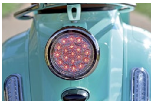
Licht-Mix: Vorn leuchtet eine herkömmliche Birne im Scheinwerfer, am Heck strahlen LEDs – mit Bremslicht richtig hell.
