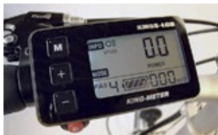
Das LCD-Display zeigt Akkuzustand, aktuelle Geschwindigkeit, Leistung in Watt sowie Uhrzeit und Kilometerstand an.
