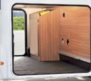
Carado punktet mit einer voluminösen (220 x 125 x 100 cm) und beidseitig beladbaren Garage. Sie ist mit Zurrösen ausgestattet, um
