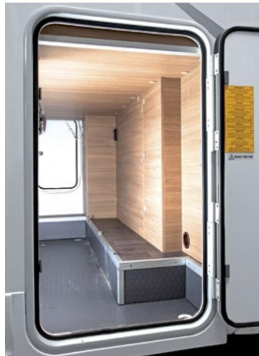
*In der zweitürigen Heckgarage fixiert Adria Zubehör, wie die Teile der Betterweiterung, sicher mit Gurten. Einzig die Verschraubungen der Zurrösen waren beim Prototypen nicht solide genug.*
