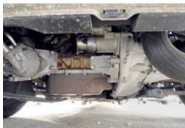
*Blick von unten: Leichter, aber harmloser Flugrost ist am Boden zu erkennen. Getriebe und Motor indes sind dicht und trocken.*
