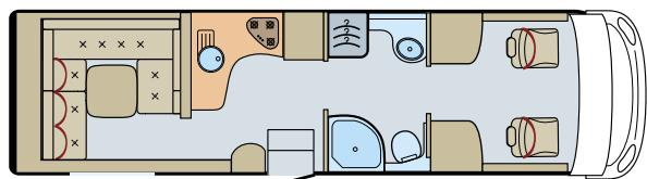
**Ungewöhnlicher Grundriss mit Zusatzzimmer.** Es bietet sich auch als Rückzugsmöglichkeit an, ob zum Fernsehen oder zum Arbeiten. Die der Länge nach ausgerichteten Einzelbetten sind zwei Meter lang.
