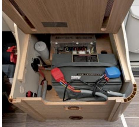
**Die Zwölf-Volt-Bordbatterie und das Ladegerät bringen Adria sehr gut erreichbar in der Truhe des Seitensitzes unter. Die Kabel liegen in Schutzrohren.**
