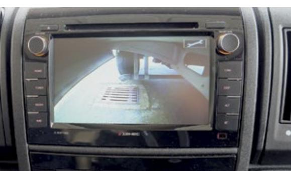
**Komfortabel:** Die Leerung des Grauwassertanks erfolgt per Tastendruck aus dem Cockpit (rechts). Eine Kamera lässt den Piloten den Ausguss korrekt über jedem Gully positionieren.
