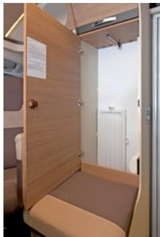
**Das Rückenpolster des Seitensitzes ist an einer Tür befestigt. Dahinter: der Kleiderschrank.**
