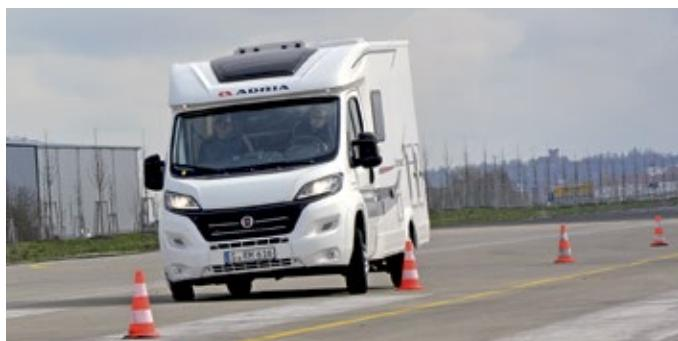
*Die Sicht nach vorne, zu den Seiten und nach hinten ist beim nur 2,12 Meter breiten Compact Plus SLS gut. Sensoren helfen akustisch beim Rückwärtsfahren. Ebenfalls hilfreich: das Aufbautürfenster.*
