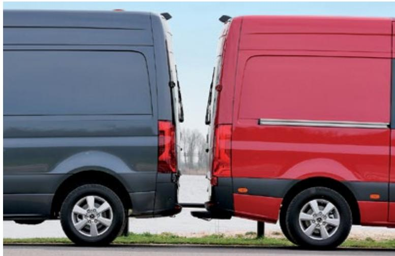
*Durch den Frontantrieb liegt der Ladeboden um 80 Millimeter tiefer, außerdem erhöht sich die Zuladung bei einem Fahrzeug bis 3,5 Tonnen Gesamtgewicht um bis zu 50 Kilo.*
