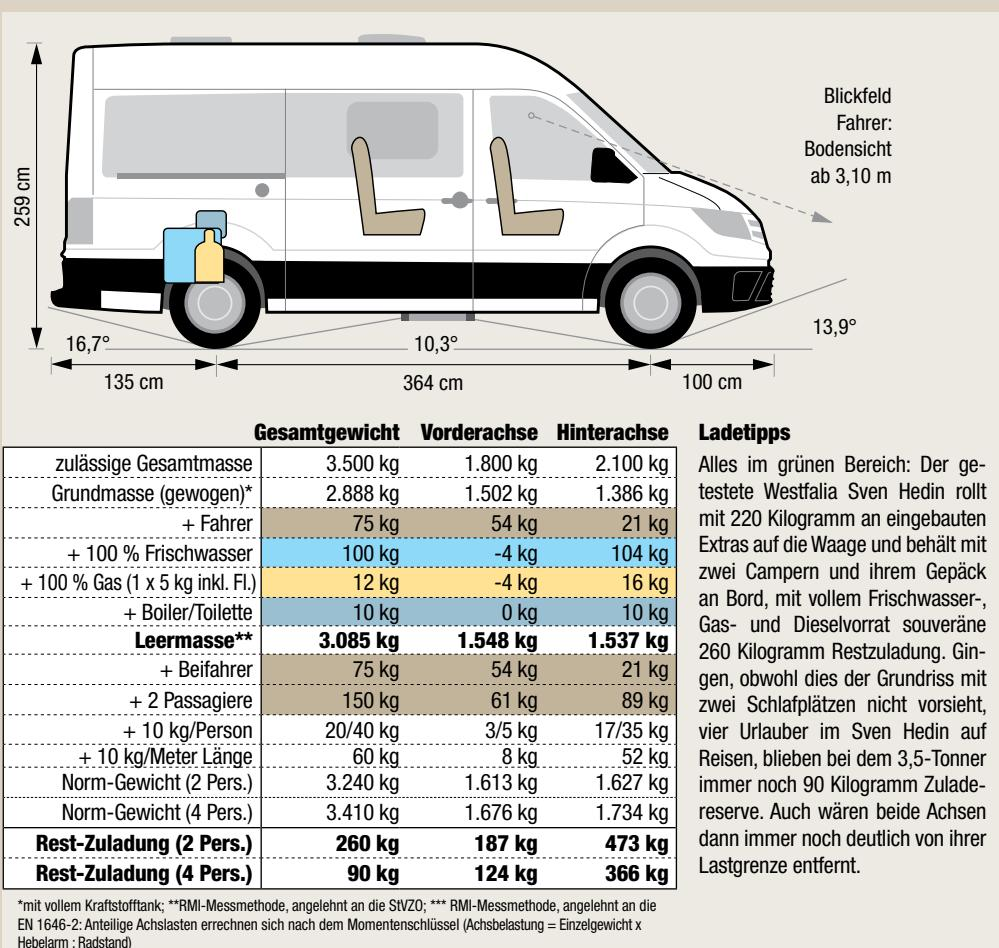
\*mit vollem Kraftstofftank; \*\*RMI-Messmethode, angelehnt an die STVZO; \*\*\* RMI-Messmethode, angelehnt an die EN 1646-2: Anteilige Achslasten errechnen sich nach dem Momentenschlüssel (Achsbelastung = Einzelgewicht x Hebelarm : Radstand)
