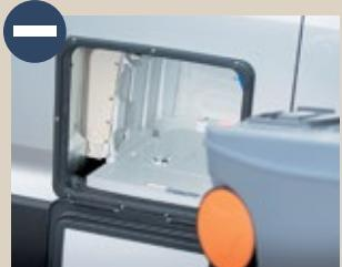
Der Toilettenschacht ist nicht gegen Flüssigkeit abgedichtet.
