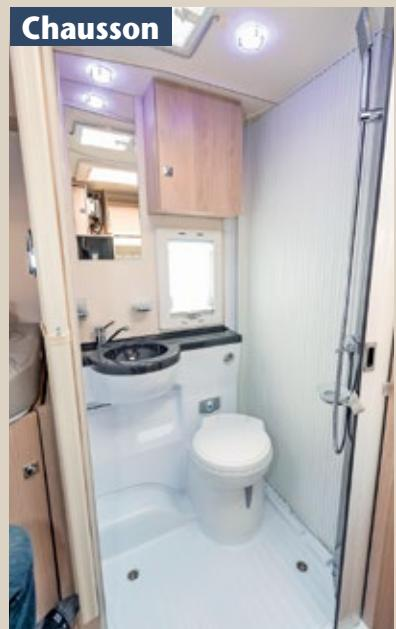
Im Bad (100 mal 70 Zentimeter) des französischen Teilintegrierten fließt das Duschwasser über zwei Abläufe in der Duschtasse ab. Auch auf unebenem Untergrund kann es deshalb vollständig abfließen.
