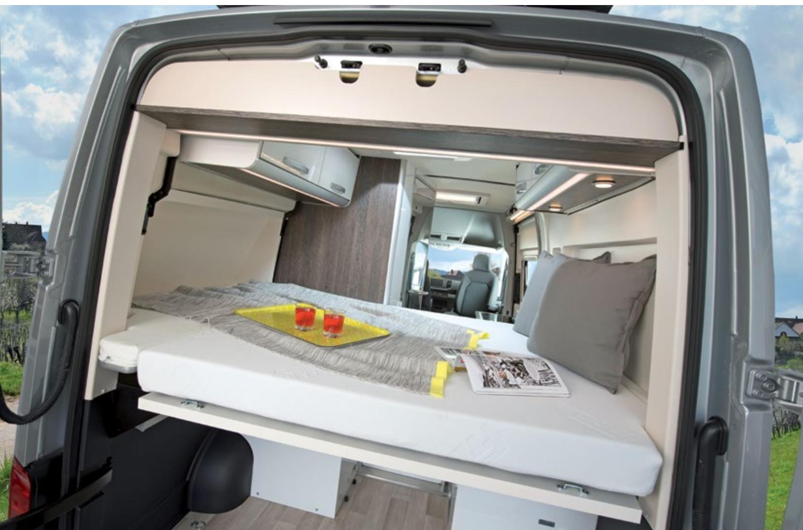
Die Karosseriebreite von 2,04 Metern kompensiert Westfalia mit einem elektrisch angetriebenen Erker, der Bestandteil des Komfortpakets ist. So erreicht der Hersteller eine Bettänge von 2,02 Meter. Die beiden an ihrer Längsseite aufstellbaren Bettzhälften lassen sich einzeln demontieren. Im rechten Staukasten unterm Bett kommt der Frischwassertank unter, im linken der von oben zu bestückende Gasflaschenkasten.
