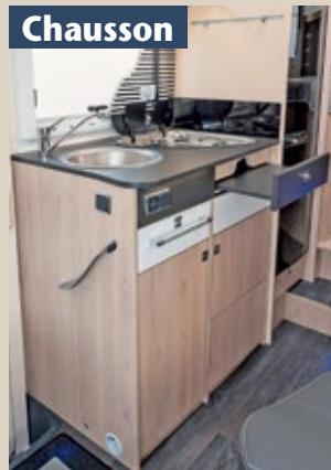
Einfallsreich: Um die Arbeits- und Ablagefläche an der 105 mal 68 Zentimeter großen Längsküche des französischen Teilintegrierten zu erhöhen, stattet Chausson sie mit einem Ausziehbrett aus.
