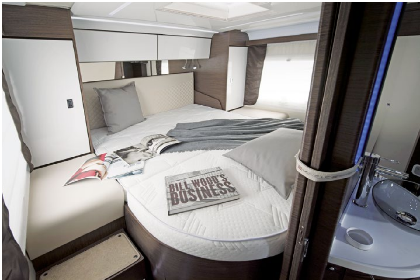
Komfortable Matratze auf Holzlattenrost im Alurahmen, elektrisch um 23 Zentimeter in der Höhe verstellbar, mit aufstellbarem Fußende und kleinem Staufach darunter – das Hubbett in der K-Yacht 79 Tekno Design.
