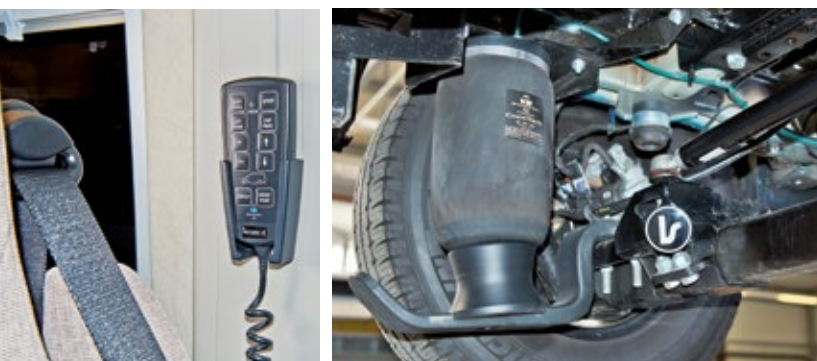
Rechts: Schön zu sehen der große Luftbalg, der die komplette Hinterachse trägt. Das Bedienteil erlaubt manuelle Einstellungen, beispielsweise Auto-Level oder Fahrwerksoptionen (Sport/Komfort).
