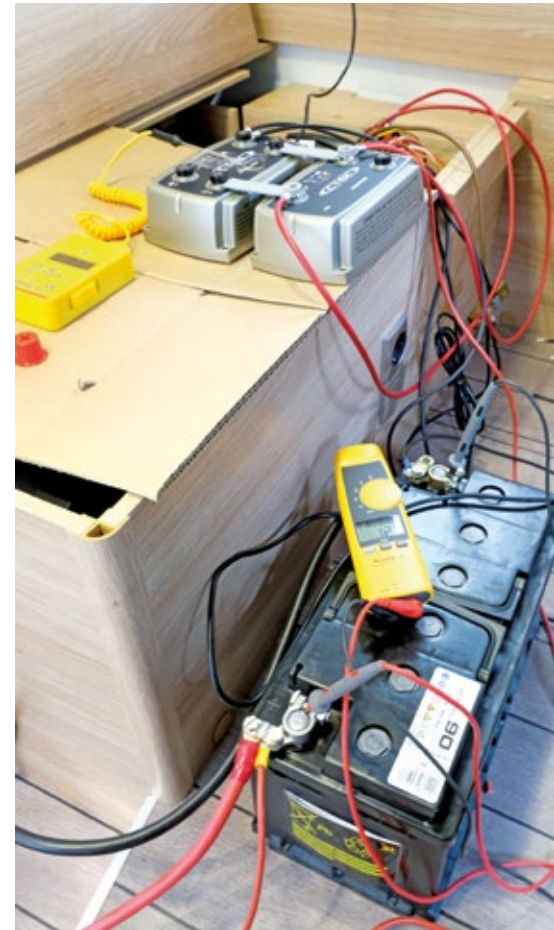
Kernproblem Batterieladung: Wer eine schnelle Aufladung während der Fahrt wünscht, kommt um einen leistungsfähigen Booster nicht herum. Hier: RMI-Vergleichstest im Mercedes Sprinter.
