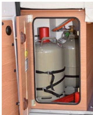
Zwei Gasflaschen sind an Bord, serienmäßig allerdings ohne DuoControl-Umschaltautomatik. Das Bett (oben) ist mit 1,89 Metern etwas kurz geraten.
