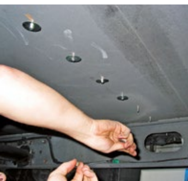
Schienen auf dem Boden der Heckgarage verschrauben Profis durch den Boden.
