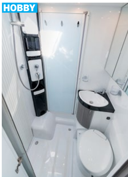
Das geräumige Bad lässt sich mittels zweier Klapptüren einfach zur vollwertigen Duschkabine umfunktionieren. Das Waschbecken füllt eine Ecke aus.
