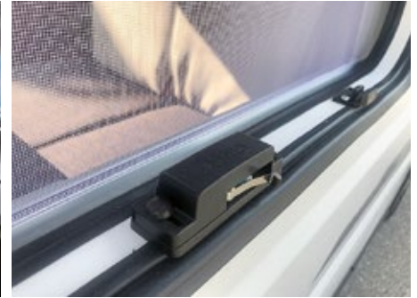
Bei geöffnetem Seitenfenster (Sensor) lässt sich die Heizung nicht starten – der Kamin ist zu nah.
