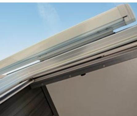
Die Heckgarage überzeugt mit viel Platz und einem isolierten Boden. Ungünstig: Zwischen Markise und Aufbau bleibt ein Spalt, durch den Regenwasser läuft. Zudem reicht sie nicht über die gesamte Breite der Tür.
