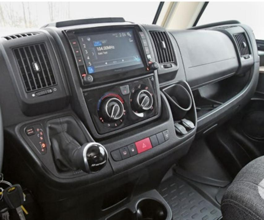
Das Armaturenbrett im überarbeiteten Fiat Ducato hat sich kaum geändert, die Kulisse für den Schalthebel des Automatikgetriebes schon. Der beleuchtete Schalter für die verschiedenen Fahrmodi ist leicht zu erreichen.
