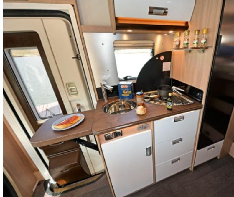
Dank dem sich bündig an die Arbeitsplatte anschließenden Klappbrett hat der Campingkoch genügend Platz. Die Rundspüle ist angenehm groß, und auch die Brennerabstände des elektrisch zündenden Herds gehen in Ordnung. Der Absorberkühlschrank mit 142 Liter Rauminhalt und integriertem Gefrierfach reicht ebenfalls für vier Personen gut aus. Der Stauraum der Küche ist für vier Leute etwas knapp bemessen. Die Ausleuchtung ist sehr gut. ►
