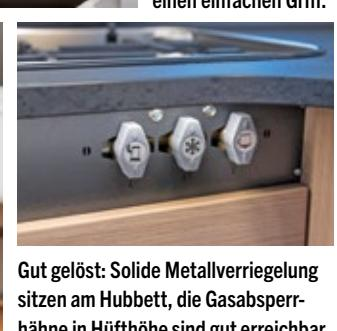
**Gut gelöst:** Solide Metallverriegelung sitzen am Hubbett, die Gasabsperrhähne in Hüfthöhe sind gut erreichbar.
