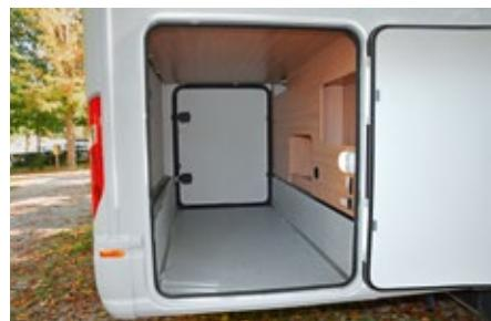
Die Heckgarage ist vom Format her gut nutzbar und mit verschiebbaren Zurrösen und rutschhemmendem Boden ausgestattet. Gut erreichbar: der Elektroschalter für den Abwasserhahn sowie der Frischwassertank. Der Abwassertank ist vom Innenraum aus zugänglich.
