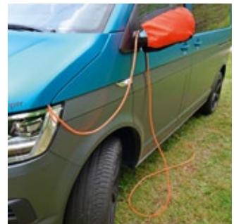
Das Landstrom-Kabel führt bei Space Camper unter die Motorhaube. Dank Kabelhülle in Signalfarbe über dem Außenspiegel, vergisst man es vor dem Losfahren garantiert nicht.
