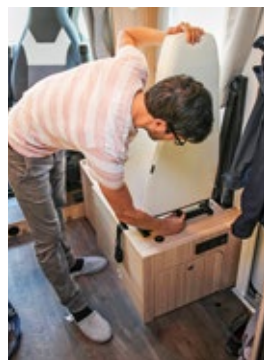
Der Umbau von einem Längssofa zu einem Fahrersitz mit Drei-Punkt-Gurt ist an sich unkompliziert und nimmt etwa zwei Minuten in Anspruch. Auf Dauer könnte das etwas lästig sein, gerade wenn der Reisemobilist täglich unterwegs ist und zweimal am Tag Hand anlegen muss. Polster entfernen, die Unterfläche entsprechend umklappen, den Sitz in die dafür vorgesehenen Löcher stecken und festdrehen. Beachten Sie, dass die Sofapolster während der Fahrt und die Sitze bei Ankunft entsprechend verstaut werden müssen.
