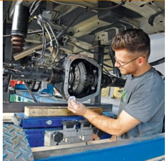
Die zuschaltbare 100-Prozent-Hinterachssperre ist eine Extrem-Eigenentwicklung und passt genau in das originale Gehäuse des Ford Transit.
