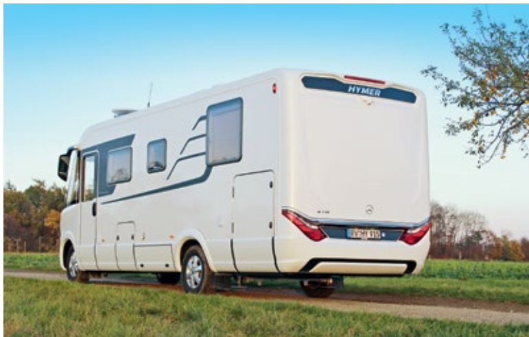
Der Hymer B-Klasse ML I 790 auf Mercedes-Benz Sprinter mit Frontantrieb und SLC-Chassis ist eine stattliche Erscheinung. Das ansprechende Heck besteht aus isoliertem GfK.
