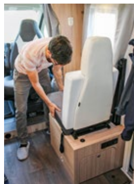
Der Umbau von einem Längssofa zu einem Fahrersitz mit Drei-Punkt-Gurt ist an sich unkompliziert und nimmt etwa zwei Minuten in Anspruch. Auf Dauer könnte das etwas lästig sein, gerade wenn der Reisemobilist täglich unterwegs ist und zweimal am Tag Hand anlegen muss. Polster entfernen, die Unterfläche entsprechend umklappen, den Sitz in die dafür vorgesehenen Löcher stecken und festdrehen. Beachten Sie, dass die Sofapolster während der Fahrt und die Sitze bei Ankunft entsprechend verstaut werden müssen.
