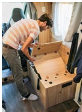
Der Umbau von einem Längssofa zu einem Fahrersitz mit Drei-Punkt-Gurt ist an sich unkompliziert und nimmt etwa zwei Minuten in Anspruch. Auf Dauer könnte das etwas lästig sein, gerade wenn der Reisemobilist täglich unterwegs ist und zweimal am Tag Hand anlegen muss. Polster entfernen, die Unterfläche entsprechend umklappen, den Sitz in die dafür vorgesehenen Löcher stecken und festdrehen. Beachten Sie, dass die Sofapolster während der Fahrt und die Sitze bei Ankunft entsprechend verstaut werden müssen.
