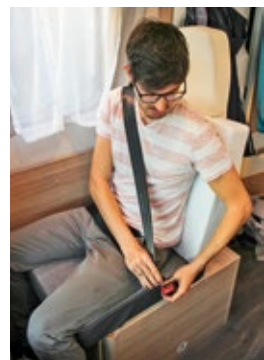
Der Umbau von einem Längssofa zu einem Fahrersitz mit Drei-Punkt-Gurt ist an sich unkompliziert und nimmt etwa zwei Minuten in Anspruch. Auf Dauer könnte das etwas lästig sein, gerade wenn der Reisemobilist täglich unterwegs ist und zweimal am Tag Hand anlegen muss. Polster entfernen, die Unterfläche entsprechend umklappen, den Sitz in die dafür vorgesehenen Löcher stecken und festdrehen. Beachten Sie, dass die Sofapolster während der Fahrt und die Sitze bei Ankunft entsprechend verstaut werden müssen.
