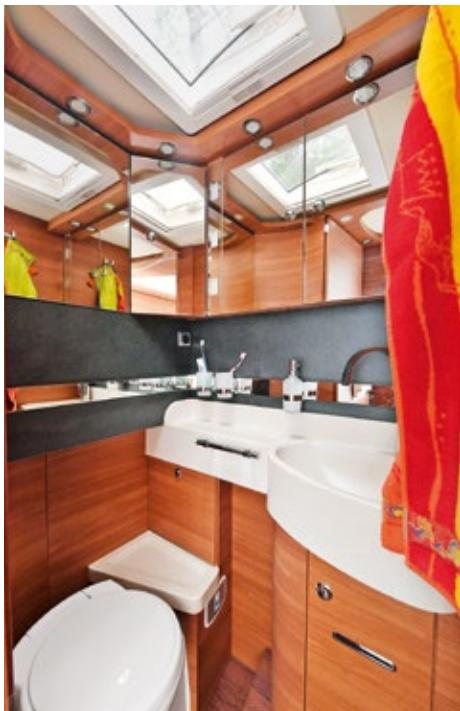
Das WC erfreut den Nutzer mit großem Waschbecken und reichlich Ablagen. Der Einbau der WC-Unterkonstruktion in einem leichten Winkel erschwert das Entsorgen der Kassette. Sie muss mühsam ein- und ausgefädelt werden.
