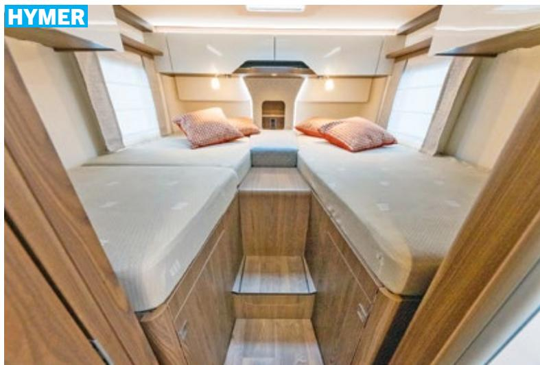
**Gediegen:** viel Platz und Komfort im Schlafzimmer. Die dicken Matratzen ruhen auf Lattenrostern. Im offenen Schrank am Kopfende finden sich USB-Anschlüsse. Die Liegeflächen klappen komplett nach oben, das ermöglicht auch Zugang zur Garage.
