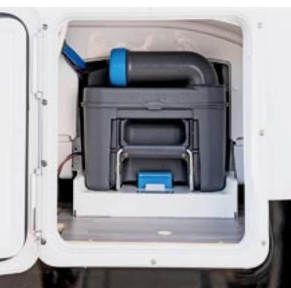
→ Hier sollte nichts daneben gehen: Ein Beispiel einer mangelhaften Montage eines Toilettenschachtes. Optimal gelöst: Die Installation oben im großen Bild. Keine Fugen oder Rinnen, wo Flüssigkeit verschwinden könnte. Perfekt zu reinigen.
