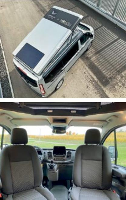
Als Option wird der Misano mit einem Solarpanel auf dem Aufstelldach ausgestattet. Üblich für einen Campingbus: Fahrer- und Beifahrersitz werden zum Wohnraum hin gedreht.
