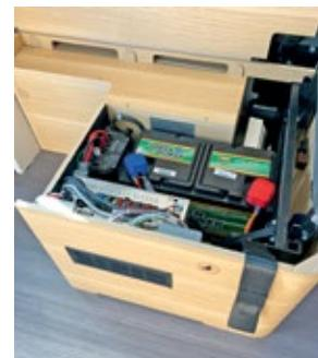
**Zentral eingebaut:** Die Elektrozentrale montiert Adria in den Sitzkasten der Längsbank auf der Fahrerseite.
