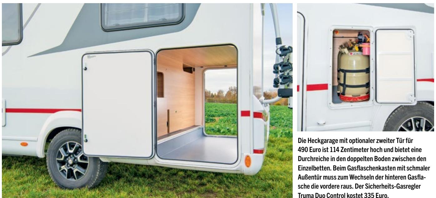
Die Heckgarage mit optionaler zweiter Tür für 490 Euro ist 114 Zentimeter hoch und bietet eine Durchreiche in den doppelten Boden zwischen den Einzelbetten. Beim Gasflaschenkasten mit schmaler Außentür muss zum Wechseln der hinteren Gasflasche die vordere raus. Der Sicherheits-Gasregler Truma Duo Control kostet 335 Euro.
