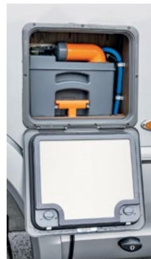
Geht besser: Der Schacht der Kassettentoilette ist nicht vollständig abgedichtet. Toll: der hohe, durchladbare Doppelboden. Darin sind die verzinkten Stahlprofile des SLC-Chassis zu erkennen.
