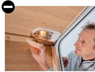
Versteckte Stromfresser: die beiden Halogenlampen in der Heckgarage.
