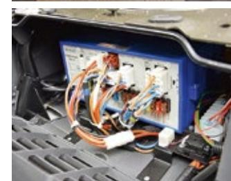
Kompakt, aufgeräumt und gut zugänglich – so wünscht man sich seine Absperrhähne, Frostwächter und FI-Schutzschalter. Der Elektro-block und die Sicherungen für die 12-Volt-Installation sind unter dem Fahrersitz untergebracht und ebenso gut erreichbar. Prima.
