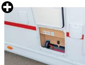
Praktisch: Servicefach mit Schalter für den elektrischen Abwasserhahn.
