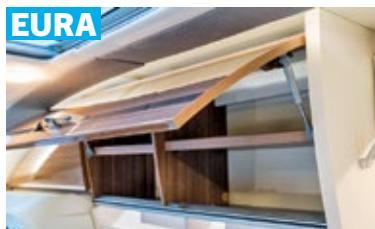
Den Oberschränken über der Sitzgruppe spendiert Eura Mobil solide Gasdruckdämpfer. Allerdings fehlt Soft-close-Technik, die Klappen schließen mit lautem Rums.
