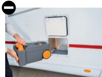
Wie so oft: Der Toilettenschacht ist nicht gegen Flüssigkeit abgedichtet.
