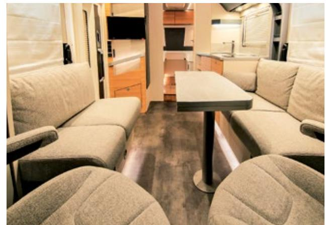
Ausklappbare Tischplatten sind die Lösung für die immer beliebter werdende gegenüberliegende Längssitzgruppe. Vor dem Ausklappen der Tischplatte wird eine Kulisse ausgezogen, die die zweite Tischhälfte von unten stabilisiert. Durch eine nachrüstbare Kulissenstütze kann die Konstruktion zusätzlich stabilisiert werden.
