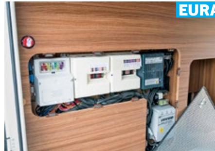
Übersichtlich: Die Elektro-Zentrale mit Sicherungen und Ladegerät installiert Eura Mobil gut zugänglich hinter einem Lochblech in der Heckgarage.
