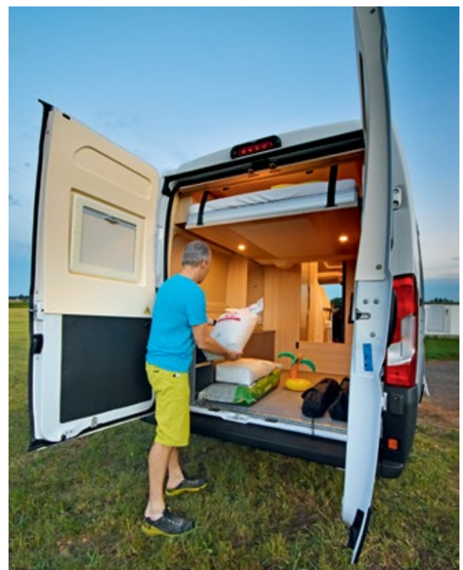
Variabel: Das Längsdoppelbett im Dreamer D60 fährt elektrisch bis unter die Decke, dann entsteht ein 145 Zentimeter hoher Laderaum für allerhand sperrige Ausrüstung bis hin zu Fahrrädern, E-Bikes oder einem Motorrad.
