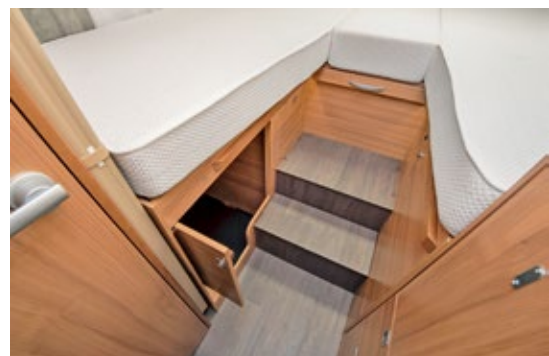
Möbeltechnik vom Feinsten: Die Türen der Kleiderschränke unter den Bettfußenden lassen sich in geöffnetem Zustand in den Schrank hineinschieben und stören dann nicht beim Entnehmen der Kleidung.
