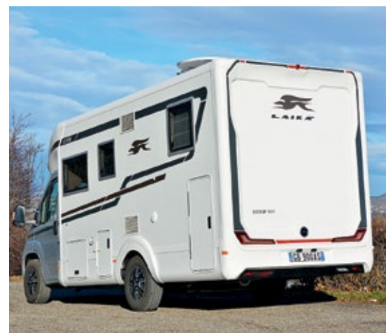
Am Heck des Ecovip finden sich LED-Rückleuchten mit Laufblinkern und eine optionale Rückfahrkamera.
