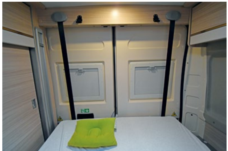
Zum Schlafen surrt das kurze Längsbett im Heck elektrisch in Position. Prinzipiell kann es in jeder Höhe genutzt werden. Ganz unters Dach gefahren bleibt freilich kein Platz mehr zum Schlafen. Die Gurtbänder der Höhenverstellung schränken die Matratzenlänge zusätzlich ein. Als Option bietet Dreamer unter dem elektrisch verstellbaren Bett noch eine herausnehmbare Zusatzliegefläche an.
