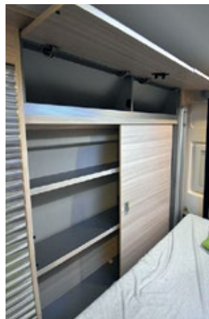
Zum Schlafen surrt das kurze Längsbett im Heck elektrisch in Position. Prinzipiell kann es in jeder Höhe genutzt werden. Ganz unters Dach gefahren bleibt freilich kein Platz mehr zum Schlafen. Die Gurtbänder der Höhenverstellung schränken die Matratzenlänge zusätzlich ein. Als Option bietet Dreamer unter dem elektrisch verstellbaren Bett noch eine herausnehmbare Zusatzliegefläche an.
