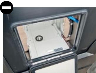
Toilettenschacht nicht gegen auslaufende Flüssigkeit abgedichtet.
