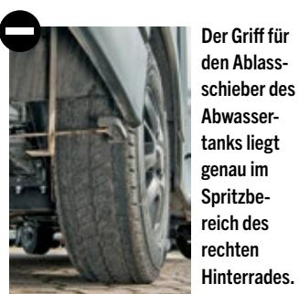
Der Griff für den Ablassschieber des Abwassertanks liegt genau im Spritzbereich des rechten Hinterrades.
