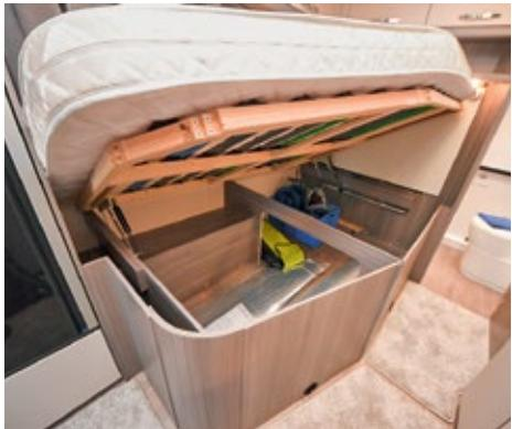
Guter Zugang: Der Lattenrost des Doppelbetts klappt per Gasdruckfeder nach oben, der Stauraum für Campingmöbel, Grill & Co. ist auch über eine Außenklappe erreichbar. Eine große Heckgarage, in der sich auch mal zwei Fahrräder verzurren lassen, ersetzt diese Lösung aber nicht.
