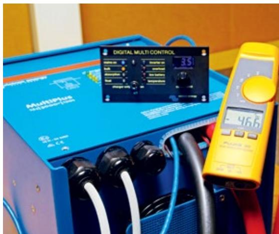
Am optionalen Multicontrol von Victron lässt sich der Eingangsstrom auf minimal 3,5 A begrenzen – das integrierte Ladegerät lädt nun mit 46,6 Ampere. Rechts im Bild: hochwertig bestückte Platine und vernünftige 230-Volt-Anschlüsse.
