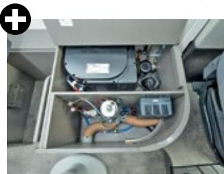
Boiler und Elektrik gut geschützt in Sitzbanktruhe montiert.
