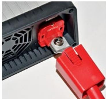
Die außenliegende Verschraubung für die Batteriekabel via Kreuzschlitzschraube und Plastikschutzkappen sowie die Lüsterklemmen für den Anschluss der 230-Volt-Anschlüsse sind technisch betrachtet nicht gerade großes Kino. Das geht funktioneller, schöner und dem Preis angemessener.
