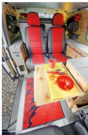
Bulli-Ausbau mal anders: Der Casper verfügt über Einzelsitze im Fond, über die ein Bett mit Couch-Funktion geklappt werden kann.
