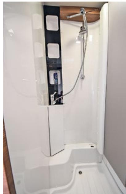
Clever: Im Bad schwenkt die Waschtischwand zur Seite und eine große Duschcabine entsteht. Die Standfläche misst großzügige 78 mal 63 Zentimeter. Wasser fließt dank zweier Abläufe auch bei leicht schräg stehendem Fahrzeug gut ab.
