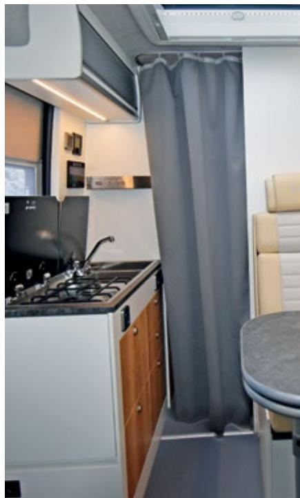
Der schwere, dichte Vorhang sorgt für Sichtschutz, Privatsphäre und Wärmeausgleich. Bei der Beleuchtung im Bad muss nachgebessert werden. Die LED-Leiste sitzt zu tief, das Gesicht vor dem Spiegel bleibt unbeleuchtet.
