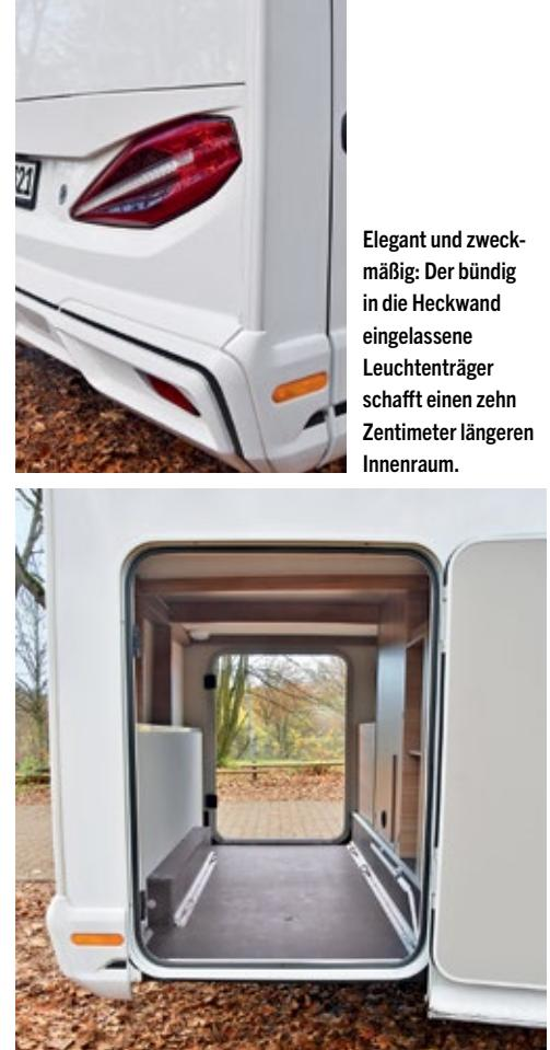
Elegant und zweckmäßig: Der bündig in die Heckwand eingelassene Leuchtenträger schafft einen zehn Zentimeter längeren Innenraum.
