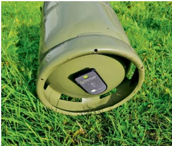
E-Trailer arbeitet mit Ultraschall. Obacht: Der Montageort birgt die Gefahr, den Sensor beim Flaschen-tausch zu vergessen.
