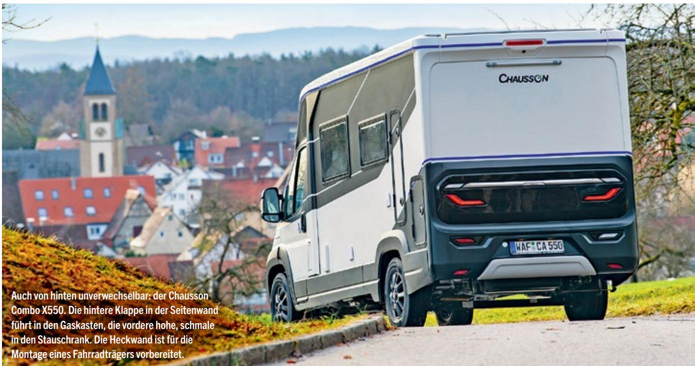
Auch von hinten unverwechselbar: der Chausson Combo X550. Die hintere Klappe in der Seitenwand führt in den Gaskasten, die vordere hohe, schmale in den Stauschrank. Die Heckwand ist für die Montage eines Fahrradträgers vorbereitet.
