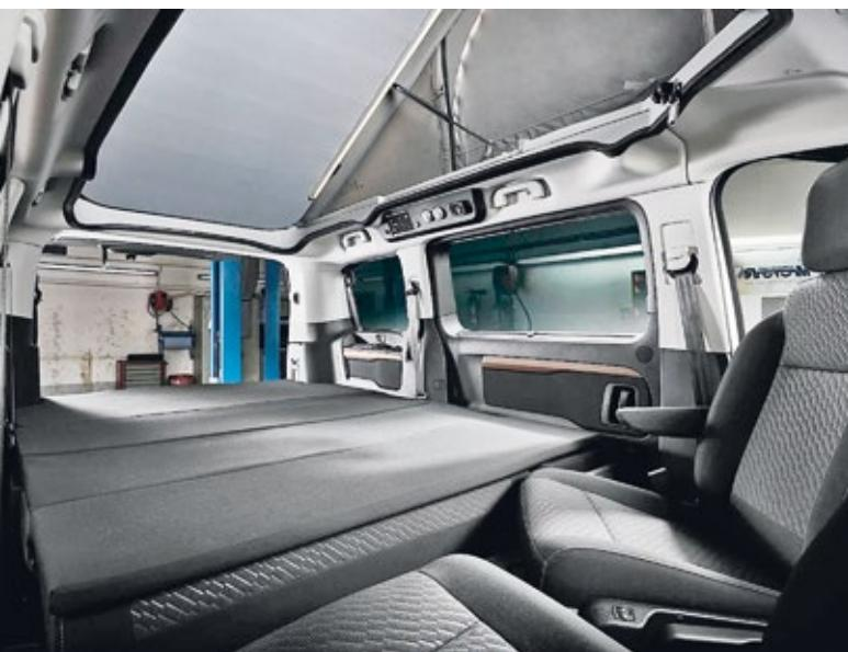
Reduzierter Ausbau: Der Crosscamp Lite verzichtet auf die feste Schrankzeile auf der Fahrerseite. Die Liegefläche reicht so über die ganze Fahrzeugbreite.
