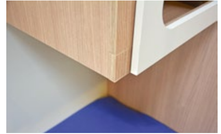
Die spitze Ecke an der Unterseite des Kleiderschranks wird von Itineo bei den Serienfahrzeugen noch gerundet.
