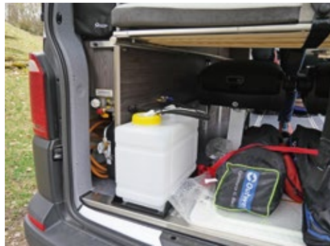
Der 20-Liter-Frischwassertank kann zum Befüllen einfach herausgenommen werden. Seitlich sitzt die Truma-Gasheizung.
