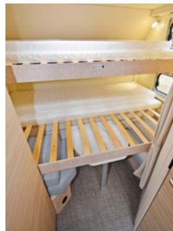
Im Heck des Activa One 690 VB genießen Kinder ihr eigenes Reich. Die Etagenbetten lassen sich durch Vorziehen der Lattenroste verbreitern. Mit je zwei LED-Spots und je einem Fenster ist das Abteil gut ausgestattet.
