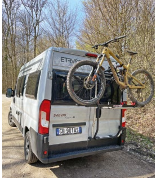
Auch der Carry Bike-Fahrradträger von Fiamma ist Teil des Editions-pakets. Mit seiner robusten Konstruktion aus Edelstahl und Aluminium und dem großen Einstellbereich ist er der Favorit der Redaktion.
