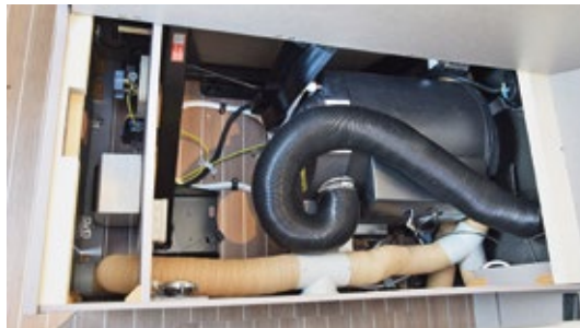
Unter dem Querbett bleibt auf 118 mal 90 mal 69 Zentimetern Platz für weitere Ausrüstung. Die serienmäßige Truma Combi-Gasstandheizung mit 4 kW Wärmeleistung ist absolut ausreichend dimensioniert.
