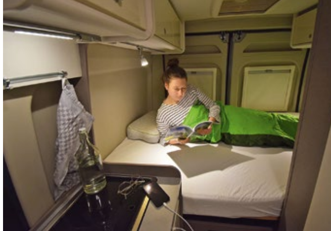
Eine Aussparung in der Schottwand dient als Aufstiegshilfe in das 85 Zentimeter hohe Bett. Zum Durchladen kann sie entnommen werden. Unten: Dass die Badtür gegen den Küchenblock stößt, wirkt etwas lieblos. Besser wäre eine Lamellenschiebetür.
