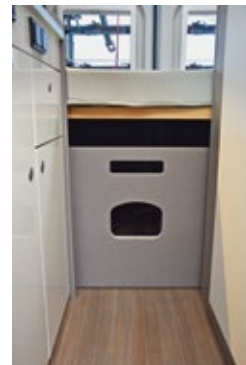
Eine Aussparung in der Schottwand dient als Aufstiegshilfe in das 85 Zentimeter hohe Bett. Zum Durchladen kann sie entnommen werden. Unten: Dass die Badtür gegen den Küchenblock stößt, wirkt etwas lieblos. Besser wäre eine Lamellenschiebetür.
