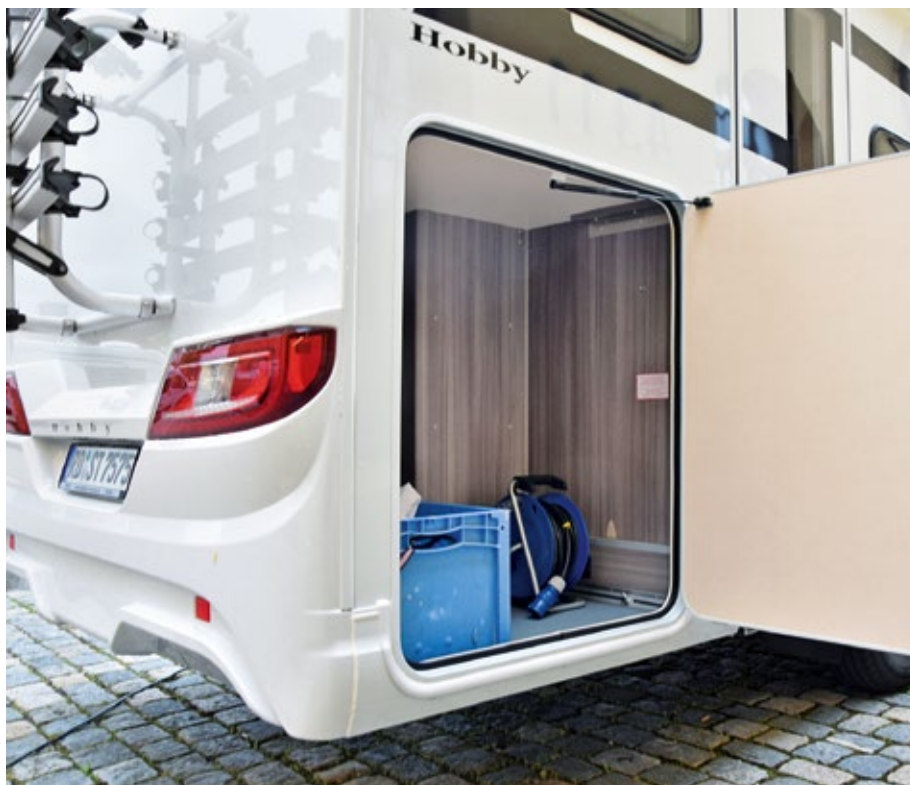
Geräumig: Die Heckgarage unter dem Bett nimmt jede Menge sperriges Gepäck auf. Die Tür öffnet an einem Gasdruckdämpfer und steht im 90-Grad-Winkel ab, um die Aufbautür nicht zu blockieren. Rückenschonend: Gasflaschenauszug.
