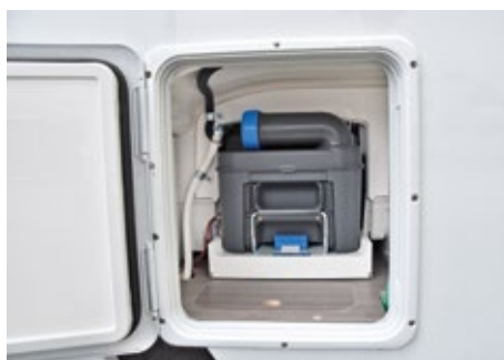
Ungeschützt: Der Schacht der Kassettentoilette ist nicht abgedichtet. Hier sollte nichts auslaufen, sonst können Flüssigkeiten in den Aufbau gelangen.
