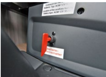
Gut erreichbar: An der Konsole des Beifahrersitzes montiert Hobby beim Optima-Ontour-Alkoven einen leicht bedienbaren Batterie-Trennschalter.
