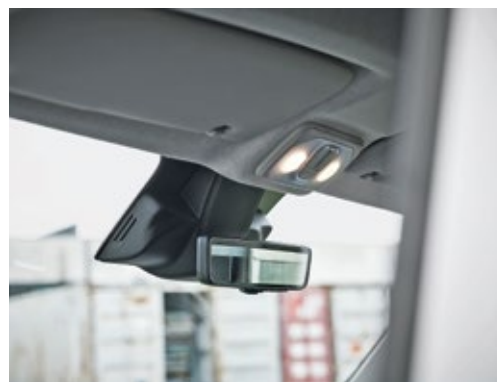
Digitaler Rückspiegel: Die Rückansicht wird per Kamera auf den Spiegel im Innenraum übertragen.
