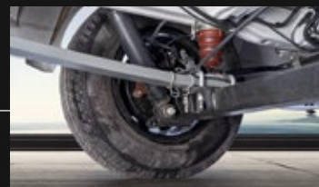
Extrem leichte Blattfedern aus Hightech-Kunststoff
