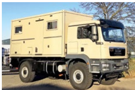
Der Wohnaufbau ist vom Basisfahrzeug unabhängig.
