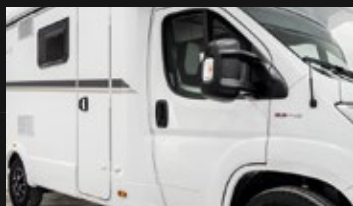
Neuer und besser isolierter Bugfender in Sandwich-Bauweise
