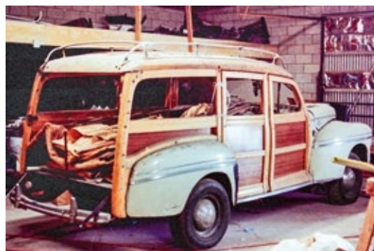
Der Bleitz-Woodie war vor seiner Restaurierung in einem erbärmlichen Zustand. Der Motor und zahlreiche Holzteile mussten komplett ersetzt werden.
