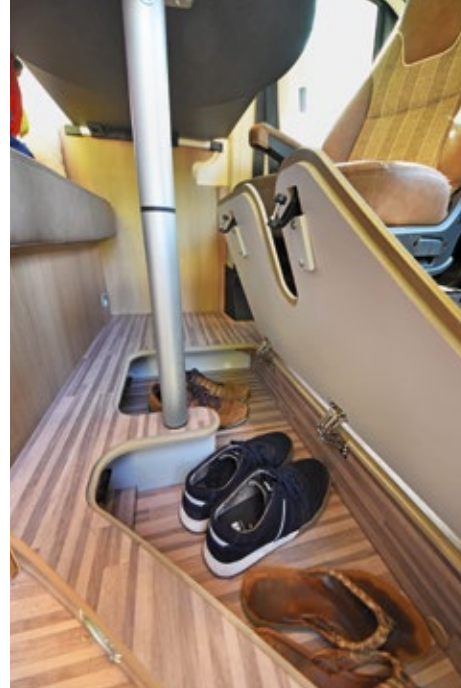
Clevere Details: Die Klappe zum Fach im Sitzgruppen-podest öffnet an soliden Scharnieren (oben). Auch die Liegefläche im Heck klappt mit einem Handgriff hoch.
