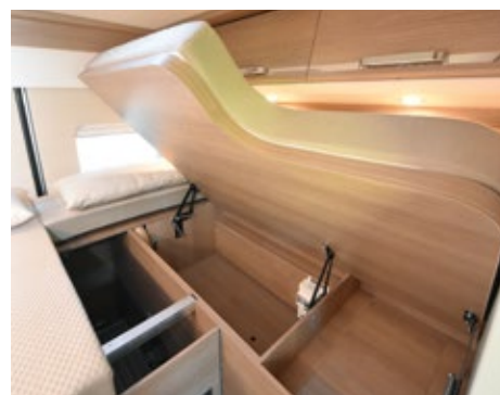
Clevere Details: Die Klappe zum Fach im Sitzgruppen-podest öffnet an soliden Scharnieren (oben). Auch die Liegefläche im Heck klappt mit einem Handgriff hoch.
