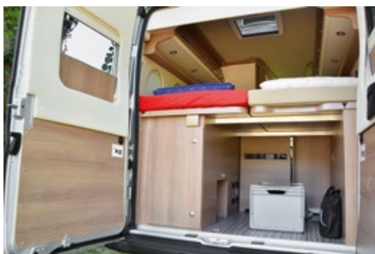
Unter der recht hoch montierten Liegefläche bleibt ein großer Heckstauraum (links). Gruß aus dem Bad: Der Schacht der Schwenk-Toilette ist konstruktionsbedingt offen (oben).
