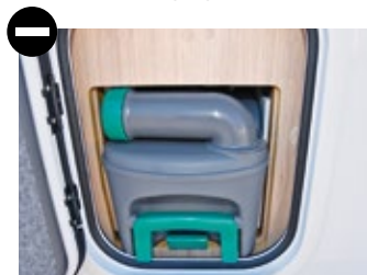
Entnahme der WC-Kassette zu eng, zudem Schacht nicht gut abgedichtet.
