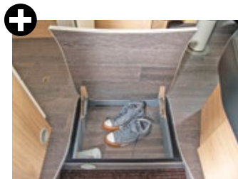
Praktisches Fach direkt am Eingang. Jedoch: Frost Control Ventil darunter.
