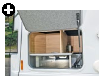
Durchladbarer Doppelboden mit großer Außenklappe an Gasdruckdämpfer.
