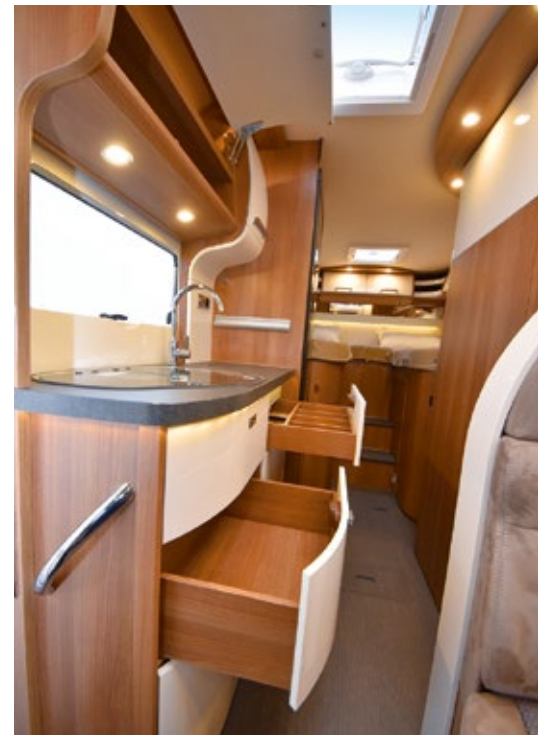
Carthago-Pressesprecher Alexander Wehrmann inspiziert die modifizierten Oberschränke. Die Vorserien-Verankerungen wurden gegen größere, mit Filz belegte Beschläge getauscht. Umfangreiches Nachstellen der Möbel verbesserte die Geräuschkulisse weiter.
