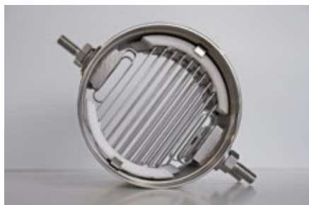
Technisch: Das Steuergerät regelt den Einsatz des SCR-Systems. Die Heizeinheit, Bild Mitte: ausgebaut, sitzt eingebaut vor dem Auspufftopf (rechts).
