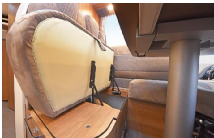
Geräuschoptimierung im Detail: Ein Flauschband auf der Holzkante der Sitzbank (schwarz) soll Klappern vorbeugen.
