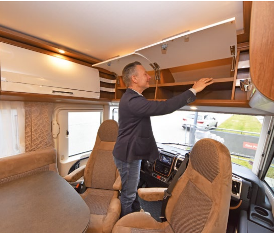
Carthago-Pressesprecher Alexander Wehrmann inspiziert die modifizierten Oberschränke. Die Vorserien-Verankerungen wurden gegen größere, mit Filz belegte Beschläge getauscht. Umfangreiches Nachstellen der Möbel verbesserte die Geräuschkulisse weiter.
