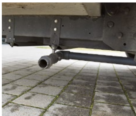
Optimiert: Der nicht ganz dicht schließende Grauwasserauslass wurde beim Check behoben. Den Hebel zum Ablassen des Grauwassers installiert Carthago sehr gut erreichbar im Doppelbodenfach direkt an der Aufbau-tür des Mobils.
