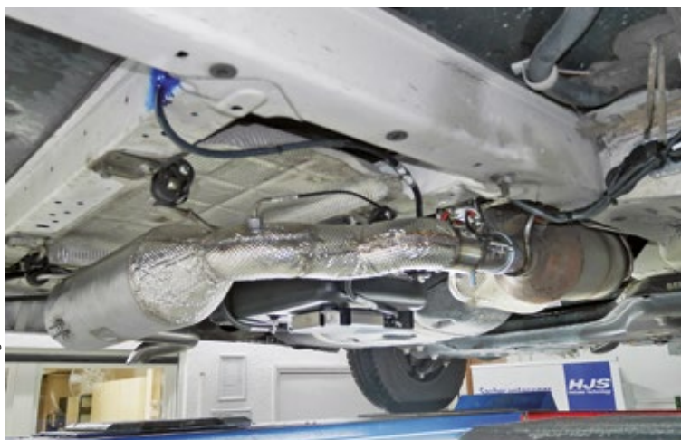
Nachgerüstet: Besonders der Auspufftopf fällt auf. Unübersehbar im Motorraum ist der Einfüllstutzen für den Ad-Blue-Tank.
