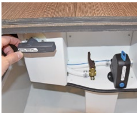
Optimiert: Der nicht ganz dicht schließende Grauwasserauslass wurde beim Check behoben. Den Hebel zum Ablassen des Grauwassers installiert Carthago sehr gut erreichbar im Doppelbodenfach direkt an der Aufbau-tür des Mobils.
