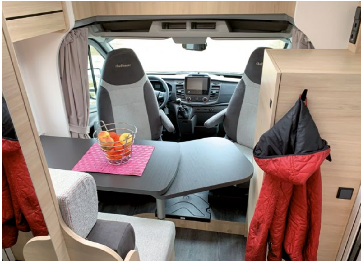
Gut gemacht: Die Tischplatte der Halbdinette lässt sich deutlich verlängern. Kleiderhaken an der Außenwand des Kleiderschranks dienen als Garderobe im Eingangsbereich des schmalen S 194.
