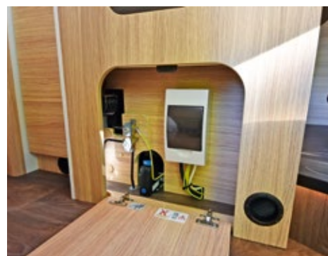
Clever: Zwischen Bad und Sitzbank passt ein Kleiderschrank. Gut zugänglich hinter einer Klappe an der Sitzbank: Frost Control, 230-Volt-Absicherung, Gashähne.
