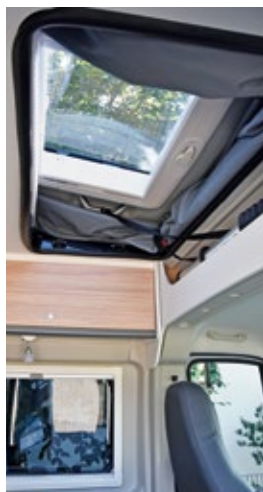
Klasse Aufstelldach mit breiter Liegefläche und bequemer Matratze. Schöne Details: Teleskopleiter auch für außen (gestaut im Dachschränk vorn), große Dachluke und USB-Steckdose.
