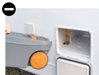
Toilettenschacht nicht abgedichtet und mit ungeschützten 12-V-Kabeln.
