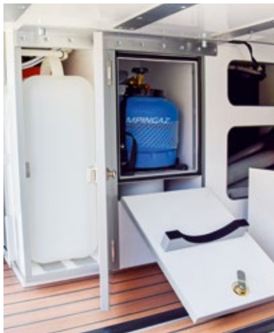
19 Liter Frischwasser und 1,8 Kilo Gas sind gut zugänglich im Heckbereich der Schrankzeile untergebracht.
