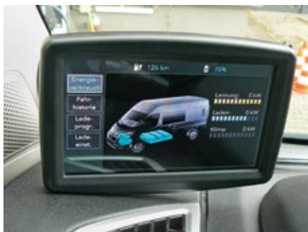
Das Powermeter rechts zeigt die aktuell abgeforderte Leistung und die Rekuperation. Detaillierte Informationen liefert ein Extra-Display am Fuß der A-Säule.
