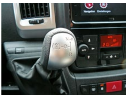
Der Wählhebel für Fahrtrichtung und Rekuperation hat bereits eine Vergangenheit im Ducato.
