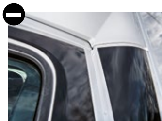
Eine Dichtnaht an den Fendern würde Scheuerstellen verhindern.
