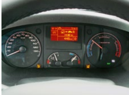
Das Powermeter rechts zeigt die aktuell abgeforderte Leistung und die Rekuperation. Detaillierte Informationen liefert ein Extra-Display am Fuß der A-Säule.
