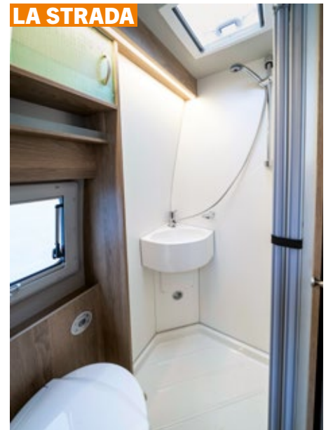
LA STRADA Separiert: La Strada räumt dem Bad mehr Platz ein, so ist hier eine separate, zum WC hin abtrennbare Duschkabine möglich. Auch hier Fenster und Dachluke.
