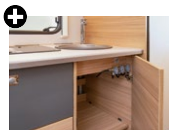
Gut erreichbare Gasabsperrröhre im Küchenunterschrank.
