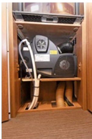
Warmluftschläuche rund ums Bett. Heizung hinter einer Blende unterm Kühlschrank. Carthago im Schneeschauer an der oberen Donau bei Beuron (oben).
