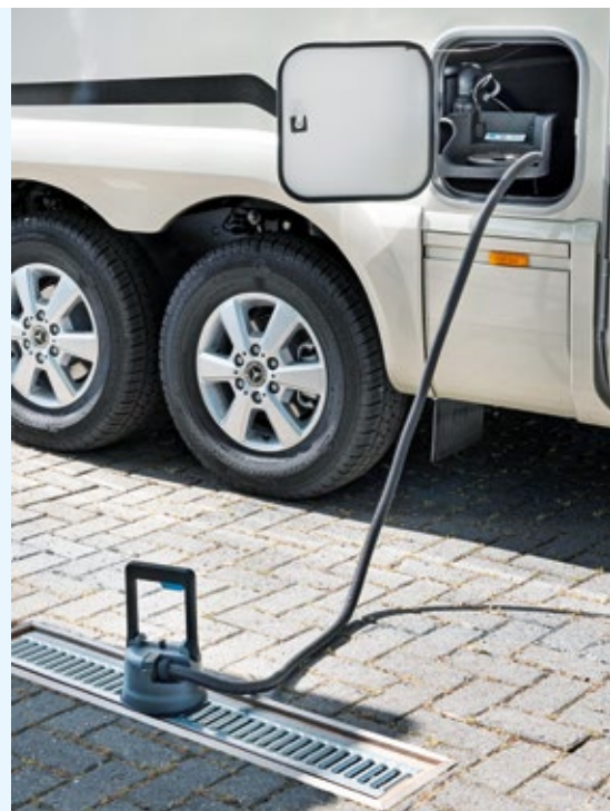
Bequeme Entleerung: Dank des Dischargers muss das Reisemobil nicht über dem Schacht stehen.
