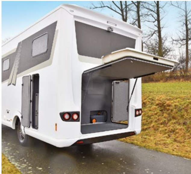
Typisch Frankia: Die riesige Heckklappe öffnet weit und erleichtert das Beladen der Garage, macht aber ein Verzurren gegen die Heckwand unmöglich.
