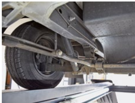
Feine Unterschiede: Während die Stahlblattfedern der Hinterachse im Sprinter doppelartig sind (Foto links), rollt der Dethleffs Globebus T6 auf Ducato mit einlagigen Blattfedern über den Asphalt (Foto rechts).
