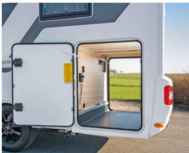
Die zweitürige Heckgarage mit isoliertem Boden aus GfK-Sandwich und zwei Bodenabläufen trägt 150 Kilogramm. Von der Garage aus kommt man nach öffnen der Schublade zwischen den Betten gut an den Frischwassertank. Im Gasflaschenkasten mit breiter Tür ist der Gasregler MonoControl CS Serie.
