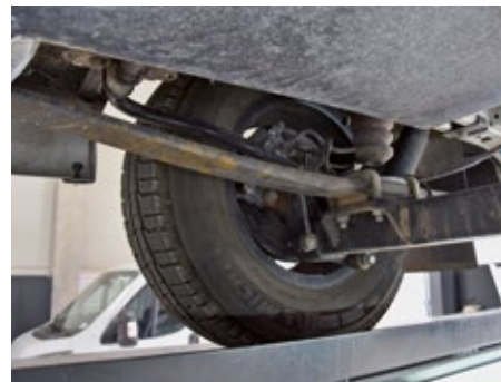
Feine Unterschiede: Während die Stahlblattfedern der Hinterachse im Sprinter doppelartig sind (Foto links), rollt der Dethleffs Globebus T6 auf Ducato mit einlagigen Blattfedern über den Asphalt (Foto rechts).
