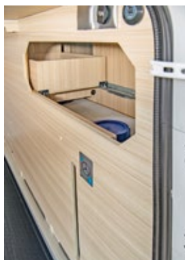
Die zweitürige Heckgarage mit isoliertem Boden aus GfK-Sandwich und zwei Bodenabläufen trägt 150 Kilogramm. Von der Garage aus kommt man nach öffnen der Schublade zwischen den Betten gut an den Frischwassertank. Im Gasflaschenkasten mit breiter Tür ist der Gasregler MonoControl CS Serie.
