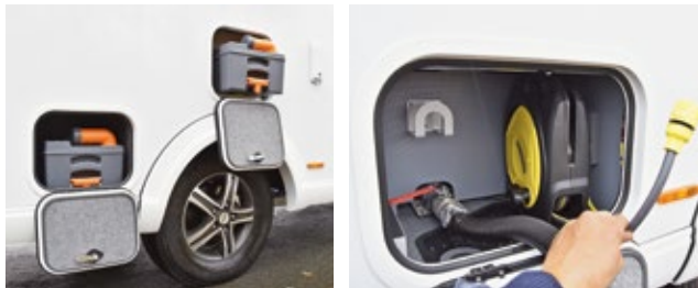
Gute Idee: Eine Ersatzkassette fürs WC reist in einem separaten Fach mit (oben links). Der ausziehbare Wasserschlauch dient zum Befüllen des Frischwassertanks (oben rechts). Gut zugängliche Elektrik.
