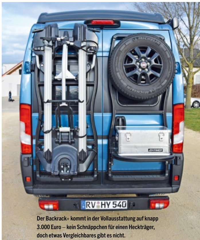
Auf das Mini Rack packt Hymer eine praktische Staukiste. Die Ratschenbänder des Biketrägers sind auch für E-Bikes ausreichend lang.
