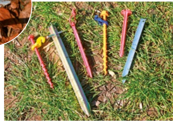
Das Testfeld: sechs Heringe, zwei zum Schrauben, vier zum Einschlagen. Links oben: Der V-Hering war nach dem Test bereits leicht verbogen.
