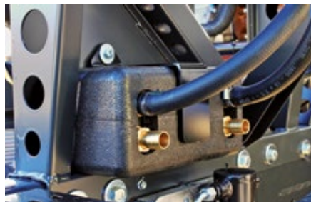
Wärmetauscher von Fahrzeugbau Meier verbindet Alde-Aufbau- mit Webasto-Motor-Warmwasserheizung.
