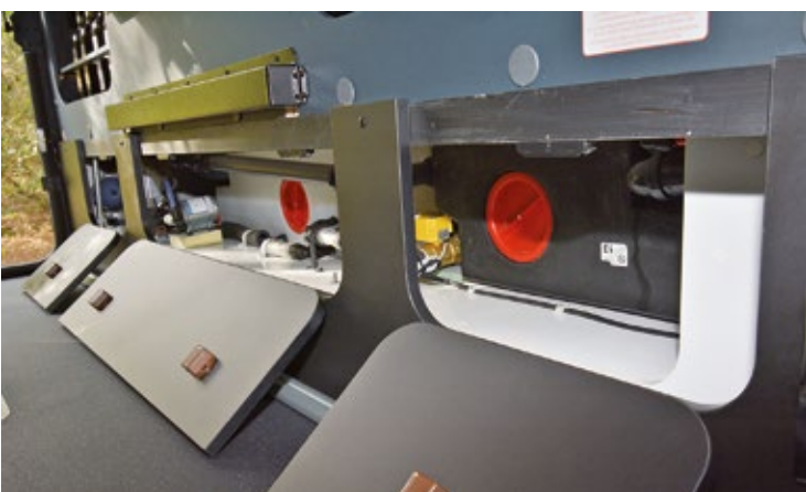
Alles serienmäßig: Sicherheitsgasregler mit Crashsensor und Umschaltautomatik, Warmwasserheizung von Alde und Abwassertank mit elektrischem Ablasshahn.
