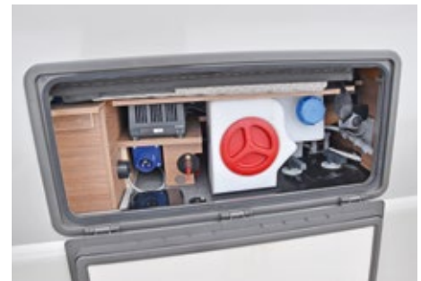
Gut gemacht: Der WC-Schacht ist zur Seitenwand hin abgedichtet. Wassertank, Ablasshähne und Stromversorgung im Servicefach. Dusch-Anschluss in der Garage.
