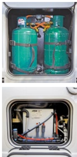
Alles serienmäßig: Sicherheitsgasregler mit Crashsensor und Umschaltautomatik, Warmwasserheizung von Alde und Abwassertank mit elektrischem Ablasshahn.
