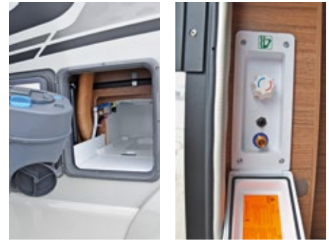
Gut gemacht: Der WC-Schacht ist zur Seitenwand hin abgedichtet. Wassertank, Ablasshähne und Stromversorgung im Servicefach. Dusch-Anschluss in der Garage.
