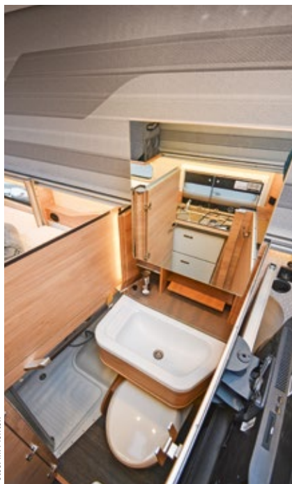
Variables Bad: Die Decke der Dusche ist eingefahren Teil der Liegefläche im Heck. Aufgestellt entsteht eine geräumige Duschkabine mit rund 190 Zentimeter Stehhöhe.
