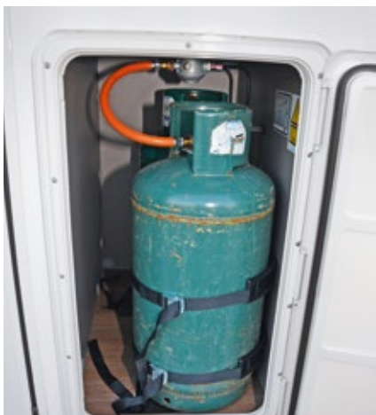
Der Gasflaschenkasten mit schmaler Tür bunkert zwei mal elf Kilogramm Gas. Unterm Kleiderschrank gut zugänglich und frostgeschützt: der 110-Liter-Frischwassertank.
