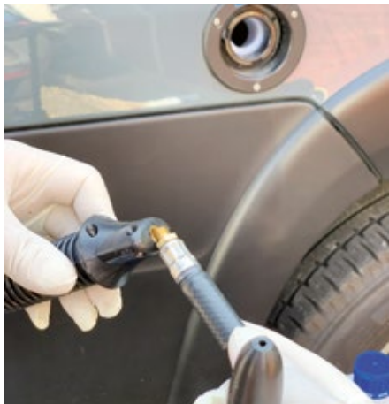
Geräteschläuche handwarm verschrauben.
