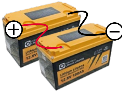
Parallelschaltung richtig gemacht: Über Kreuz wird das Bordnetz angeschlossen.
