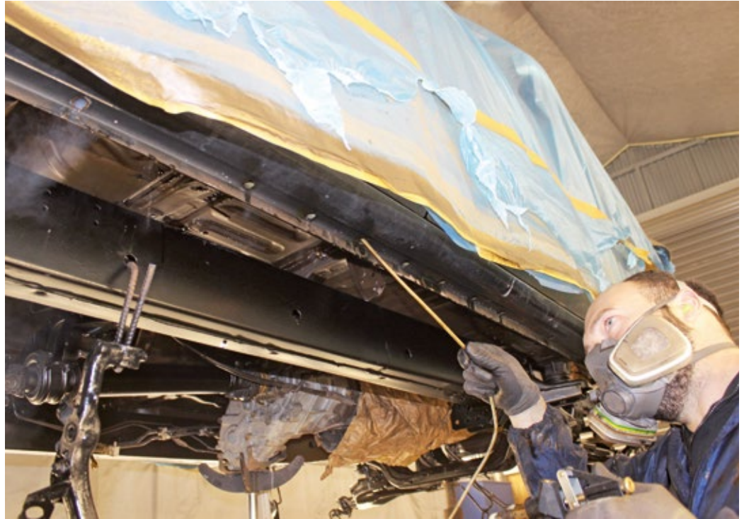
Unter der Radhausinnenschale (oben) erstrahlt der Neuwagen noch rostfrei, eine aufwendige Entrostung entfällt. Der richtige Moment, um in Eigenregie eine solide Rostschutzversiegelung aufzubringen.
