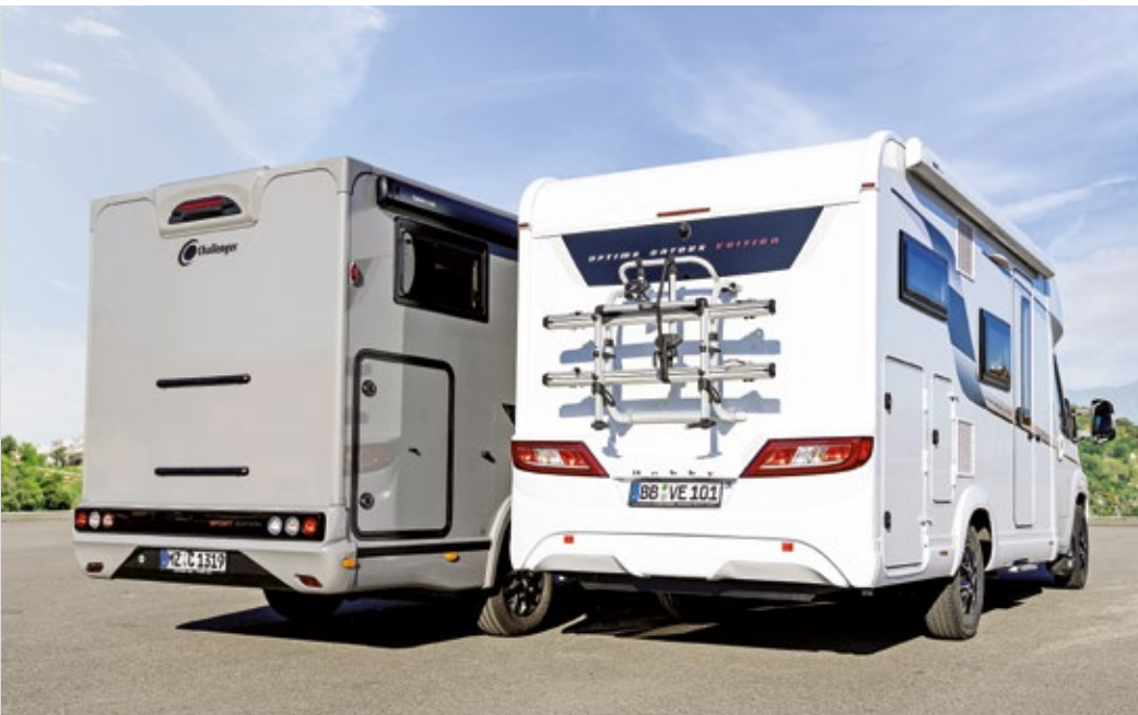
Ansichtssache: Hobby setzt auf große Heckleuchten auf halber Höhe, die schneller ins Sichtfeld des nachfolgenden Verkehrs rücken. Challenger verbaut hingegen kleine Leuchten im unteren Bereich der Rückwand.
