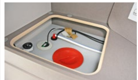
Der Gasflaschenkasten mit schmaler Tür bunkert zwei mal elf Kilogramm Gas. Unterm Kleiderschrank gut zugänglich und frostgeschützt: der 110-Liter-Frischwassertank.
