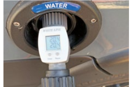
Hilfreiches Tool: Grobfilter und Wasserzähler in einem.
