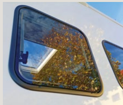
Acrylglasscheiben werden durch Temperaturunterschiede und durch Sonneneinstrahlung/UV-Strahlung rissig.
