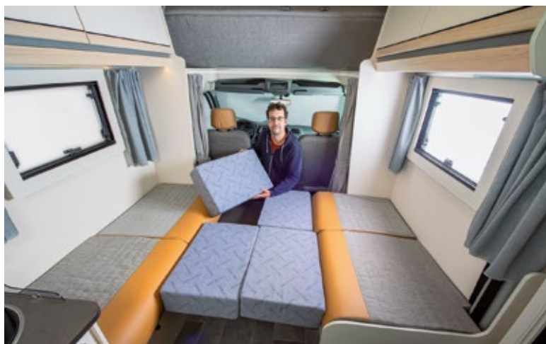
Die Matratze im Alkoven liegt auf Holzlattenrosten. Der hintere Teil der Liegefläche lässt sich aufstellen.
