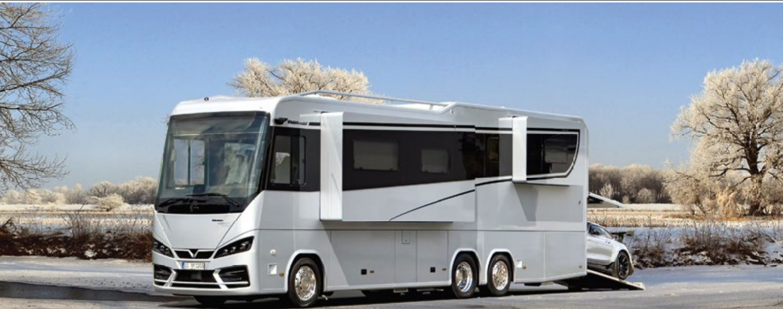
VARIO PERFECT 1200 PLATINUM. MB Actros 2553 LLL. Drei Achsen, vier Erker, 12 m, 26 t, 530 PS. Mercedes-Benz AMG GT an Bord, oder auch ein Mini SE Elektro.
