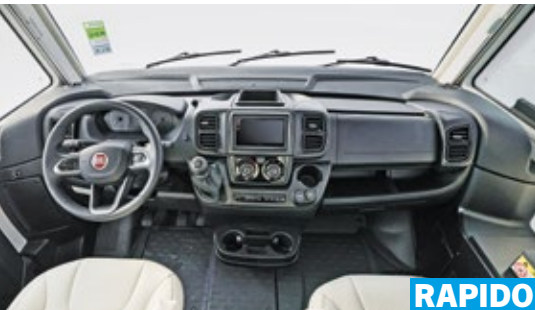
Gleich drei Scheibenwischer räumen die große Panorama-Windschutzscheibe von Regenwasser frei.
