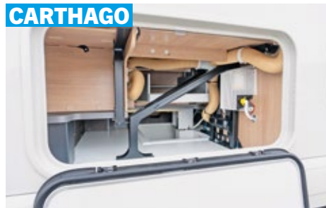
Der große, isolierte und beheizte Doppelboden erhöht das Stauraum-Volumen des Integrierten. Der Camper erreicht ihn über Klappen in Außenwand und Fußboden.
