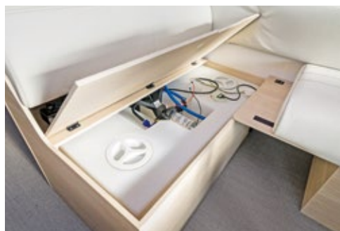
Ein Außenstauraufach beherbergt den CEE-Stroman-schluss. Der Frischwassertank sitzt fest arretiert in der Sitzbank. Die Truma-Diesel-Heizung verbaut Rapido unter dem Einzelbett auf der Fahrerseite – nachts akustisch präsenter als beim Einbau unter der Sitzbank.
