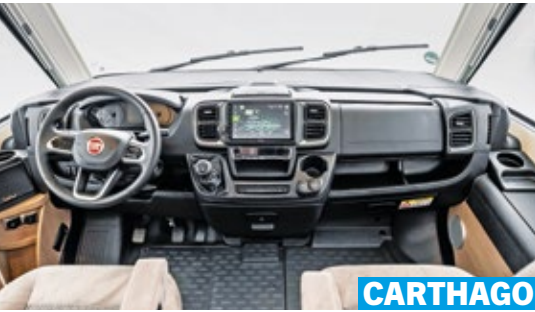
Das Armaturenbrett des C-Compactline schrägt sich zur Scheibe hin ab und optimiert so die Sicht.
