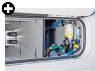
Große, frostgeschützte Ablasshähne für Frisch- und Abwassertank.
