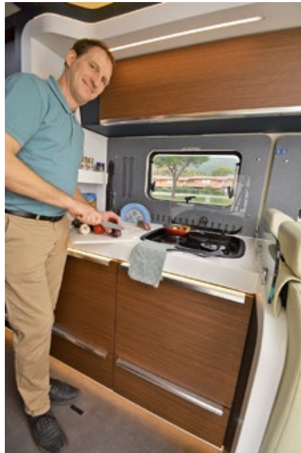
Die Küche hält viel Arbeitsfläche und jede Menge gut nutzbaren Stauraum bereit. Die Arbeitsplatte besteht aus dem acrylgebundenen Mineralwerkstoff Getacore. Ein elektrischer Dachlüfter zieht Kochdünste ab.
