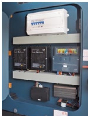
Die Elektrik ist vorbildlich installiert und sehr gut geschützt. Zwei 20-A-Ladegeräte halten den 12-Volt-Betrieb am Laufen.
