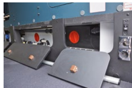
Der 25 Zentimeter hohe beleuchtete Stauraum-Doppelboden ist isoliert und beheizt und von innen und außen zu beladen. Von der Heckgarage aus sind Frisch- und Abwassertank, beide frostgeschützt, leicht zugänglich.
