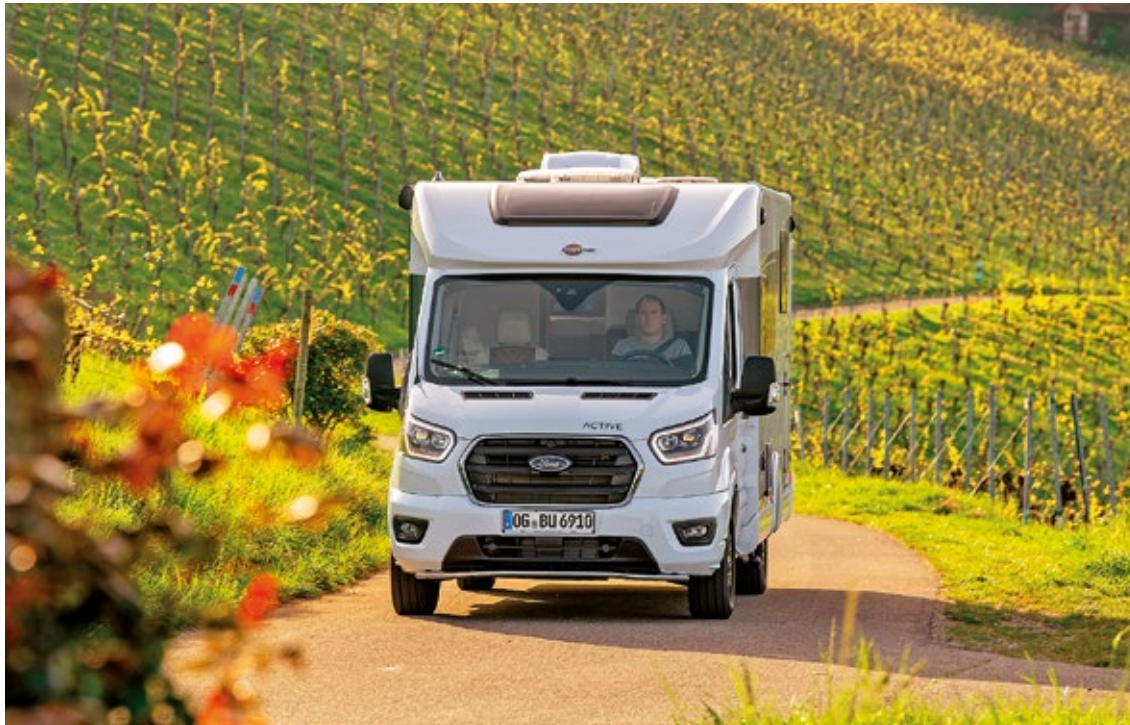
Von vorn gut zu erkennen: Der nur 2,20 Meter breite Aufbau überragt das Fahrerhaus kaum. Im Test hat sich der Ford Transit als Basis bewährt.
