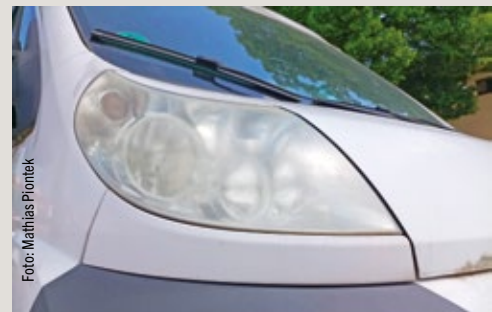
Konnte bei den guten alten Glas-Scheinwerfern nicht passieren: Scheinwerfer mit Streuscheibe aus Polycarbonat verändern sich im Laufe der Jahre unter intensiver Sonneneinstrahlung.
