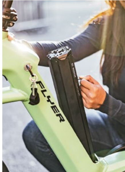
Bei im Rahmen eingebauten Akkus sollte der Käufer darauf achten, dass dieser von oben oder seitlich eingesetzt wird. So ist er besser vor Schmutz und Nässe geschützt.
