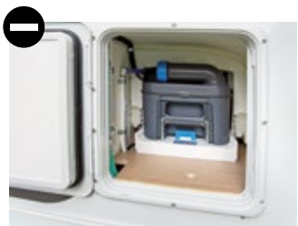
Der WC-Schacht ist nicht gegen auslaufende Flüssigkeit geschützt.
