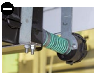
Die nach unten stehenden Gewinde der Tankbänder sollte Hobby kürzen.
