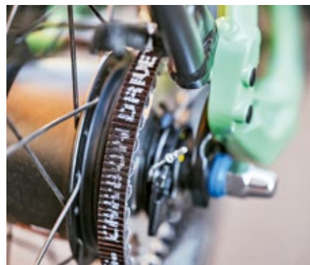
Links: Scheibenbremsen am kompakten Qio-Bike. Oben: Zahnriemen ersetzen bei vielen E-Bikes mittlerweile die klassische Kette. Sie sind wartungsarm und müssen nicht regelmäßig geölt werden.
