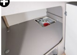
Frischwassertank mit Zugang über Deckel und Wartungsplatte in Garage.
