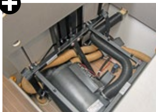
Gasheizung und Frostschutzventil gut zugänglich in Sitzbanktruhe installiert.
