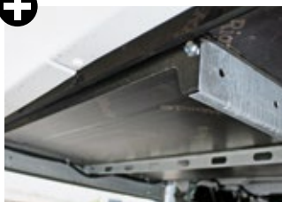
Die schwarze Quertraverse entschärft die Enden der Rahmenverlängerung.
