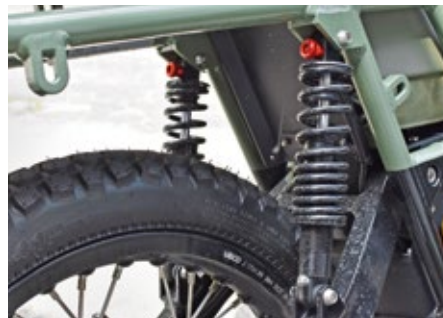
Das pistentauglich ausgelegte Fahrwerk mit einstellbarer Druck- und Zugstufe bietet viel Komfort. Die hydraulischen Scheibenbremsen sind großzügig dimensioniert.
