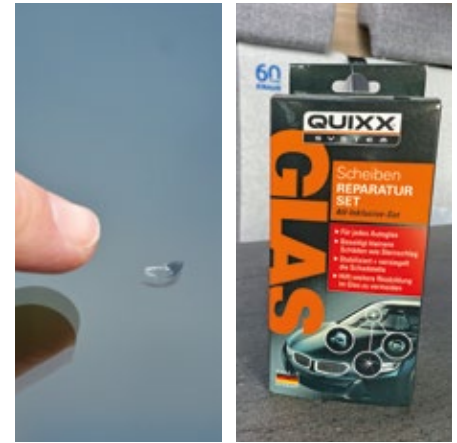
Dieser Steinschlag erfüllt alle Bedingungen für eine Reparatur. Das All-Inclusive-Set von Quixx soll's richten.
