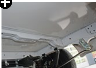
Bei Etrusco schützt eine GfK-Schicht den Unterboden.
