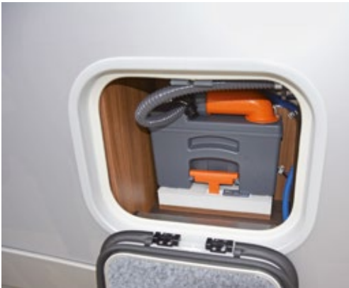
Große Garage mit gut geschützter Elektrik hinter Lochblech. Weniger gut: Den Schacht der Kassetten-Toilette dichtet Carthago nicht ausreichend ab.
