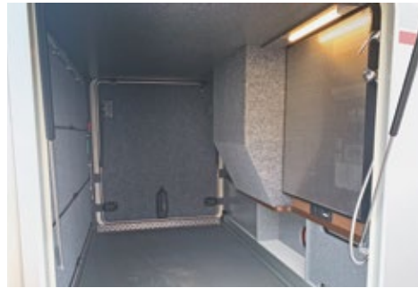
Große Garage mit gut geschützter Elektrik hinter Lochblech. Weniger gut: Den Schacht der Kassetten-Toilette dichtet Carthago nicht ausreichend ab.
