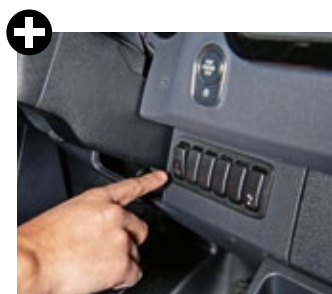
Das Ablassventil des Abwassertanks öffnet und schließt elektrisch.
