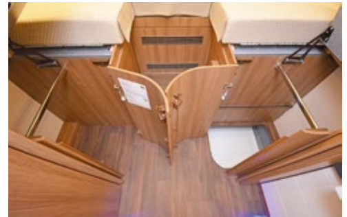
Große Garage mit gut geschützter Elektrik hinter Lochblech. Weniger gut: Den Schacht der Kassetten-Toilette dichtet Carthago nicht ausreichend ab.
