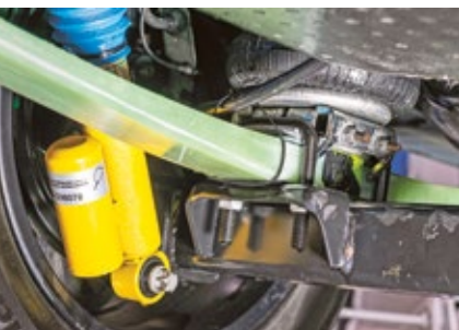
Von ORC Exklusiv optimierte Ducato-Hinterachse mit GfK-Blattfeder von Mubea und VB Airsuspension Luftbalg.
