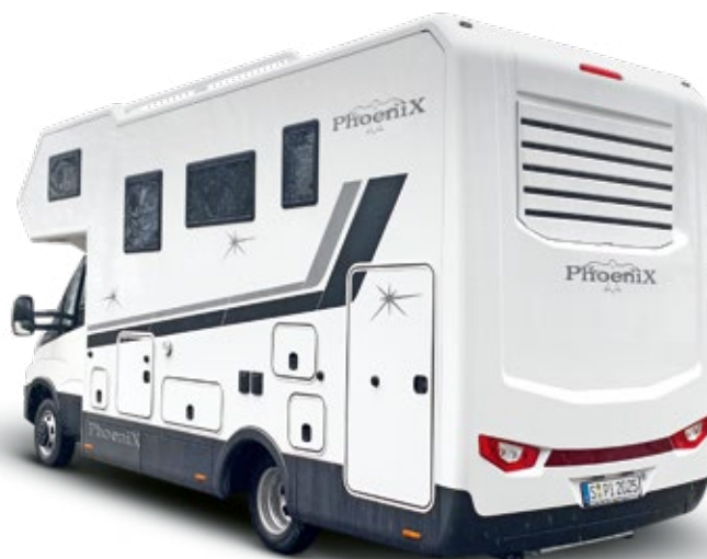
Imposant: Das hoch aufragende und 42 Millimeter dicke Omnibus-Heck des Alkovenmobils wird in Alu-PU-Alu-Sandwichbauweise gefertigt.
