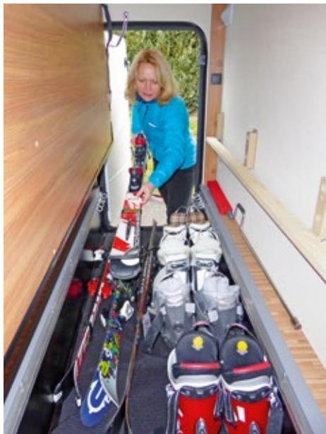
Wer die Heckgarage mit schwerem Gepäck füllt und außerdem noch Fahrräder auf einem Heckträger transportiert, riskiert, die Hinterachse zu überladen.
