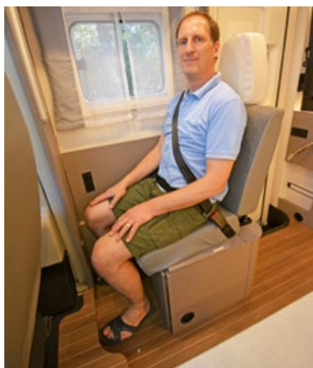
Den Umbau der beifahrerseitigen Sitzbank zum Sitz mit Dreipunkt-Sicherheitsgurt hat man im Nu erledigt. Die Rückenlehne ist ein solides Schraub-Steckteil.
