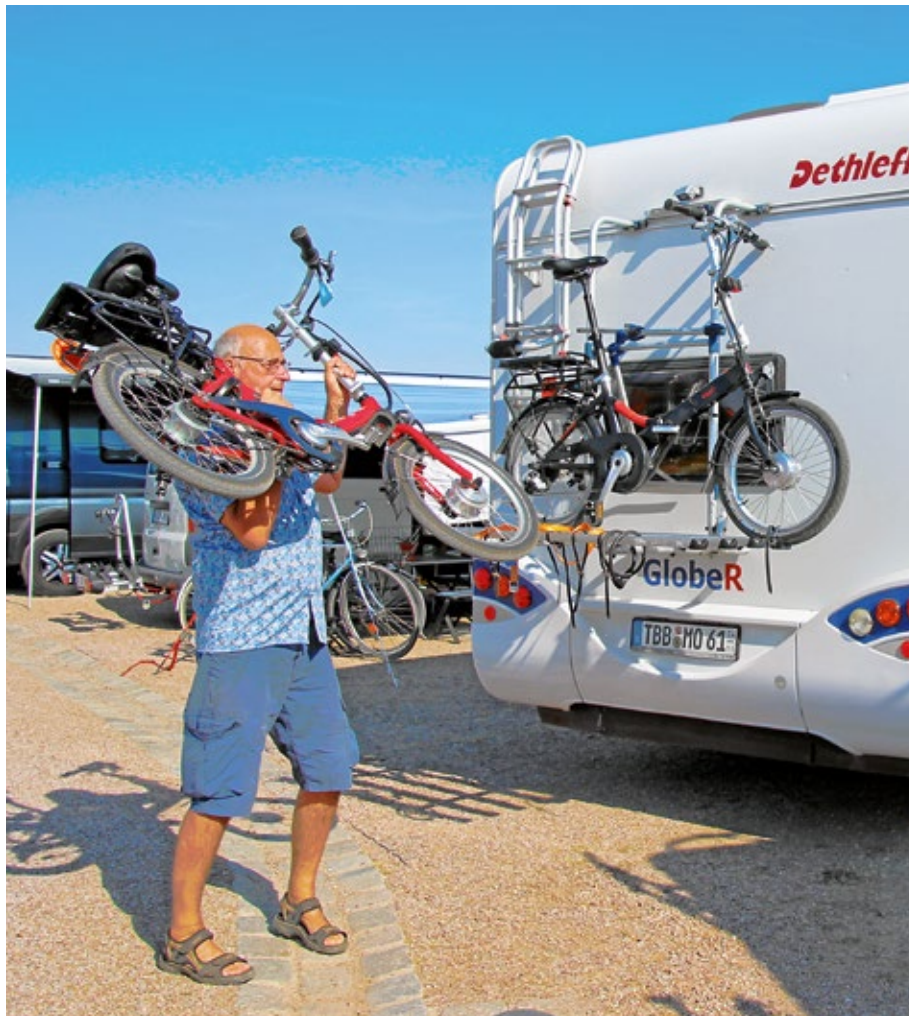
Wer die Heckgarage mit schwerem Gepäck füllt und außerdem noch Fahrräder auf einem Heckträger transportiert, riskiert, die Hinterachse zu überladen.
